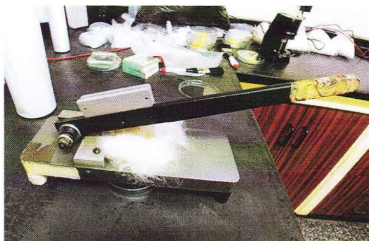
Fig. 13. Muestras de fibra cortadas a 2 mm de longitud con la ayuda de una guillotina manual.
