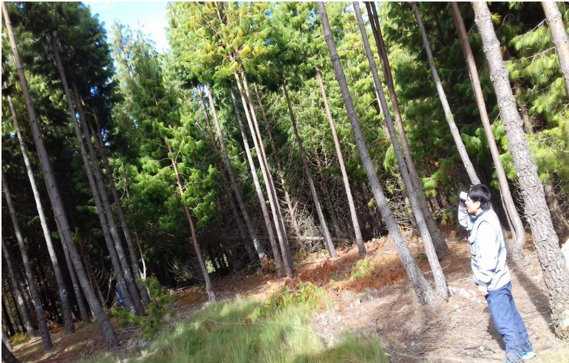
Figura 12: Medición de la altura de los árboles con hipsómetro de Suunto.
