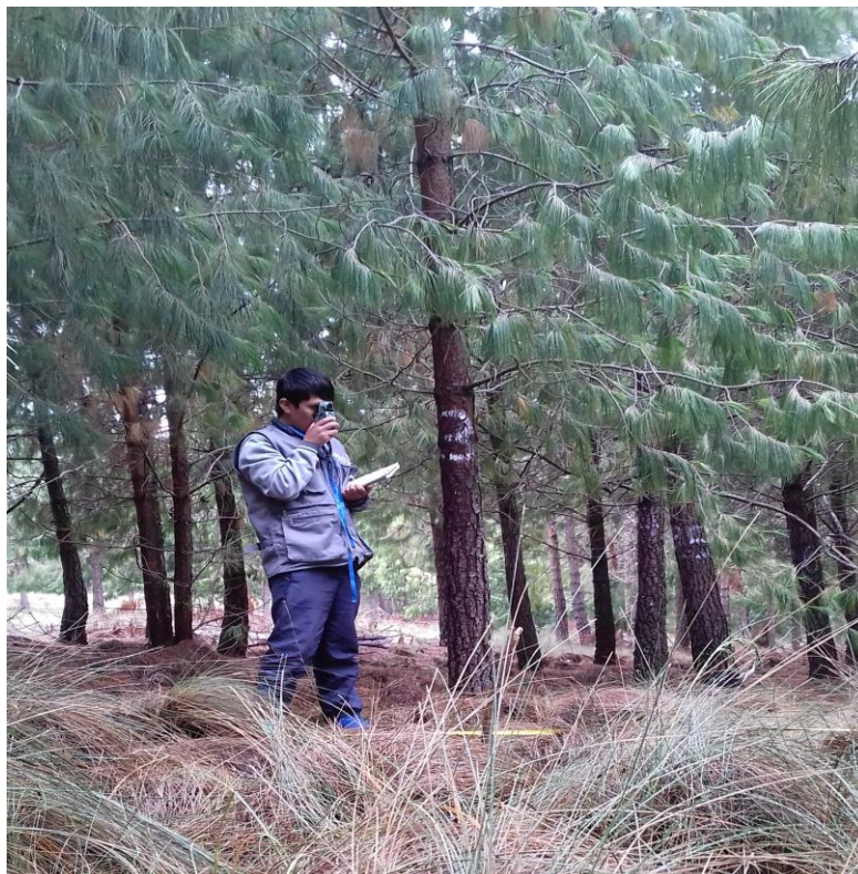
Figura 14: Medición en la base del árbol con relascopeo de Bitterlich.
