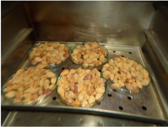
Foto 13 y 14. Secado de la semilla en el horno para encontrar el Contenido de Humedad
