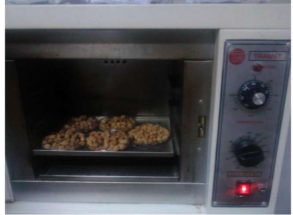
Foto 13 y 14. Secado de la semilla en el horno para encontrar el Contenido de Humedad
