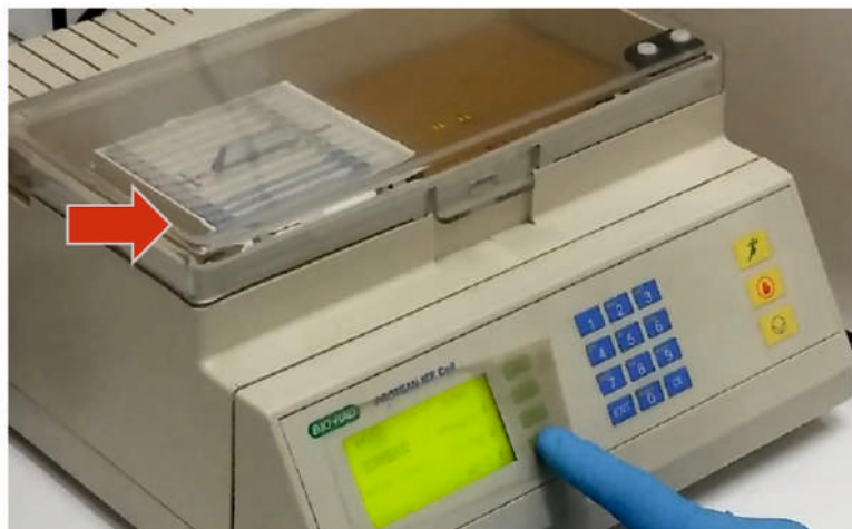
Fotografía 7. Primera Dimensión: Isoelectroenfoque. Las proteínas se separan según sus puntos Isoeléctricos.
