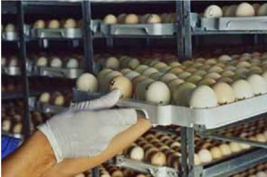
**Fig. 15.** Cargado de bandejas a la maquina incubadora.
