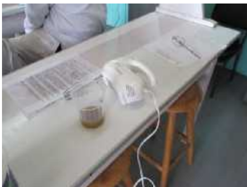
Fig. 12. Agitador eléctrico para la Técnica Modificada por Rojas y Torrel.
