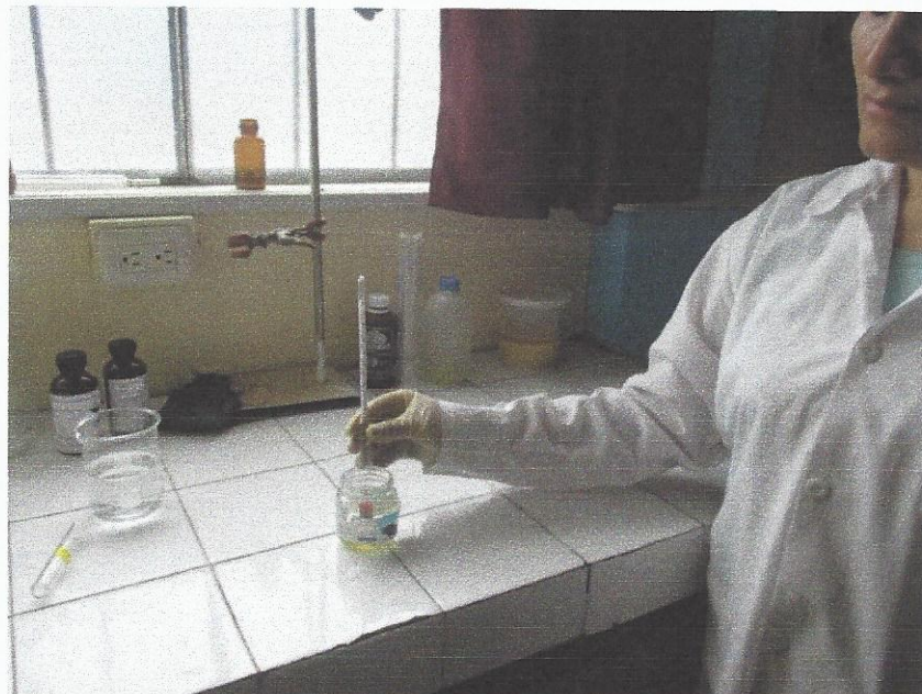
Fig. 7. Determinación de la densidad del líquido pleural. Laboratorio de Química y dinámicas de la Universidad Nacional de Cajamarca.
