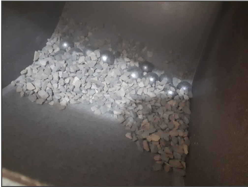
Figura 52. Colocación de la muestra en el interior de la máquina de los ángeles
