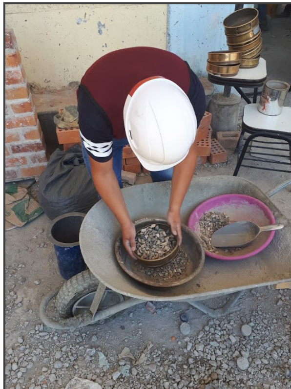
Figura 43. Análisis granulométrico del agregado grueso mediante tamizado
