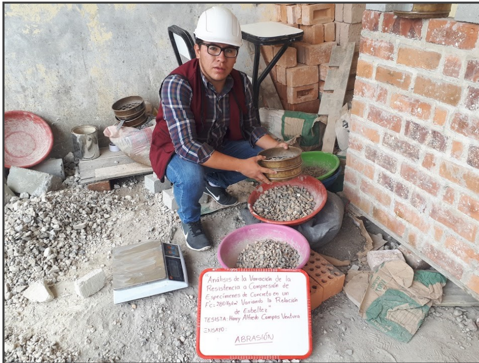
Figura 50. Preparación por tamizado de la muestra para el ensayo de abrasión
