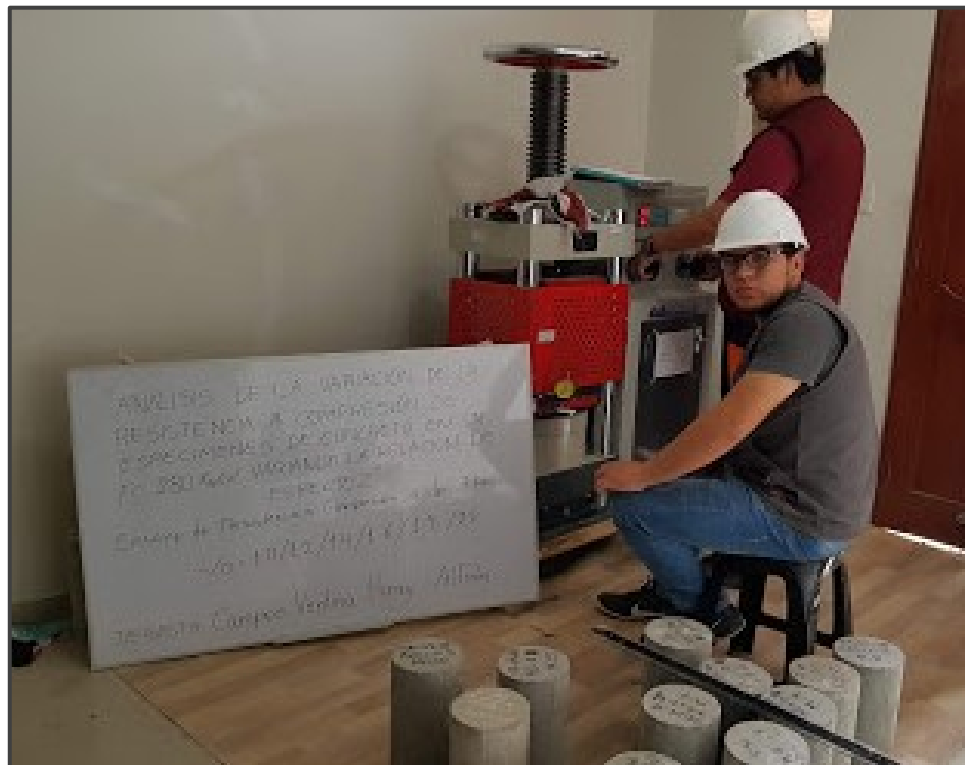
Figura 63. Lectura del deflectómetro para la elaboración de las curvas esfuerzo VS: deformación
