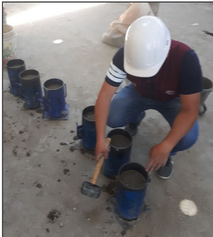
Figura 57. Llenado y compactación de probetas.
