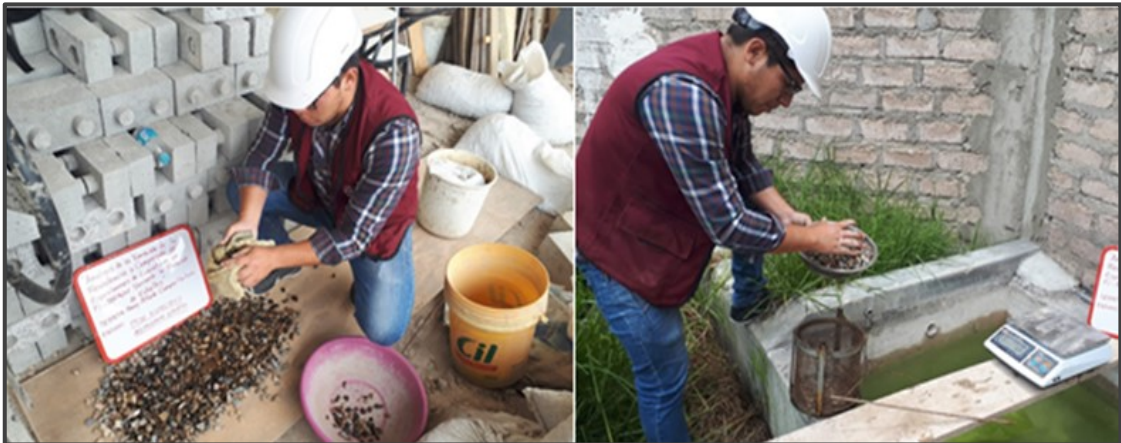
Figura 39. Ensayo para determinar el peso específico y absorción del agregado grueso
