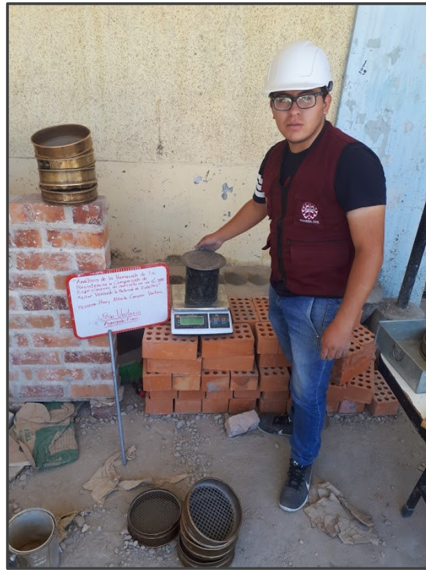
Figura 46. Peso unitario del agregado fino
