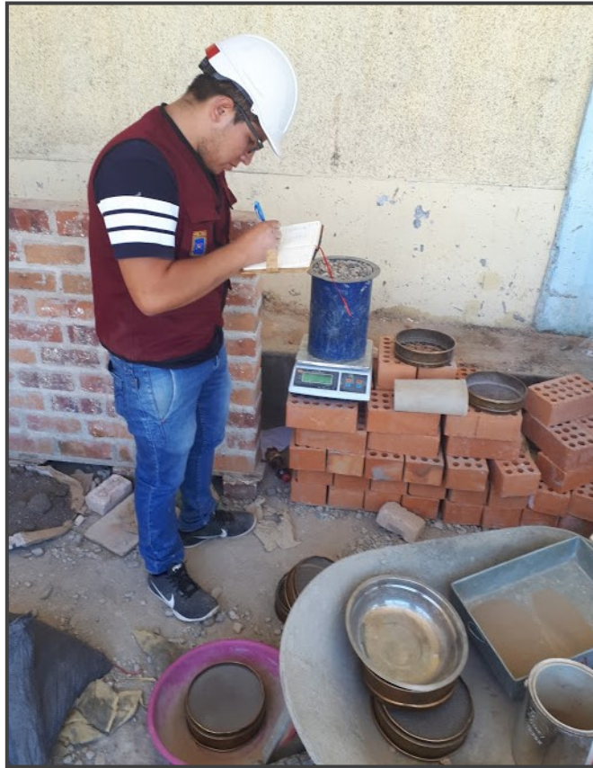
Figura 48. Peso unitario del agregado grueso
