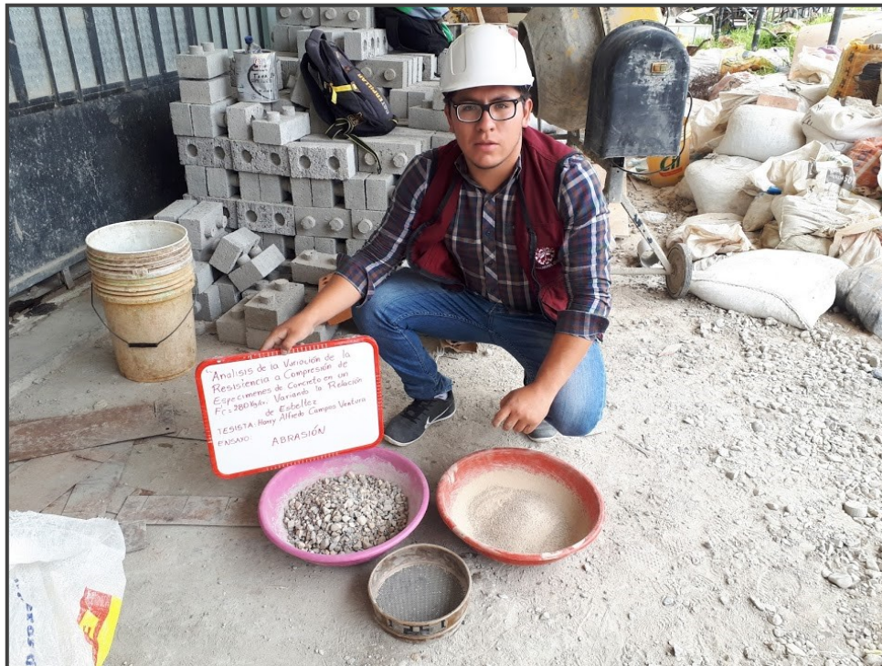
Figura 54. Tamizado de la muestra por el tamiz N° 12 para determinar el desgaste a la abrasión
