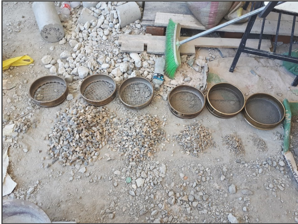
Figura 44. Pesos retenidos por las mallas, N° ¾”, N° ½”, N° 3/8”, N° 4 y , N° 8 y N° 16
