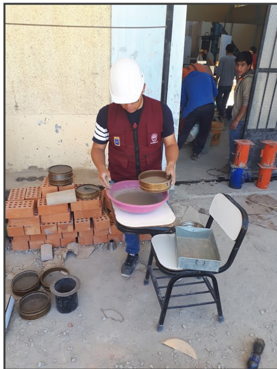
Figura 41. Análisis granulométrico del agregado fino mediante tamizado
