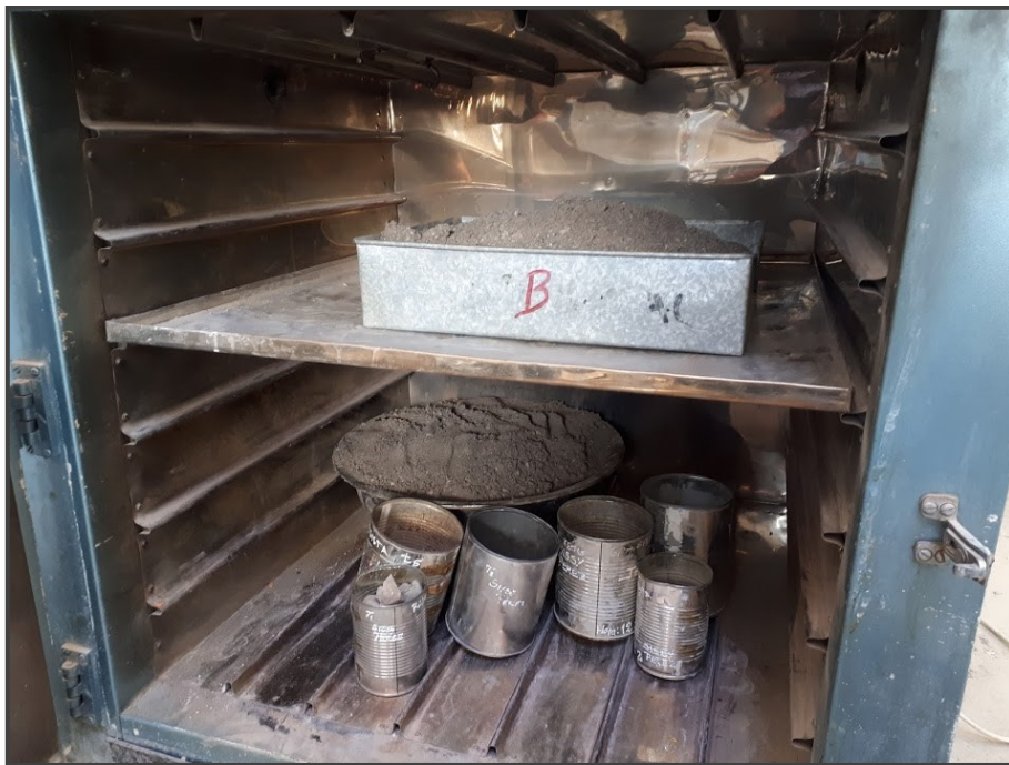
Figura 49. Ensayo de contenido de humedad de agregado fino y grueso
