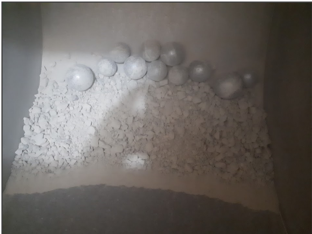
Figura 53. Muestra final, producto del ensayo de abrasión
