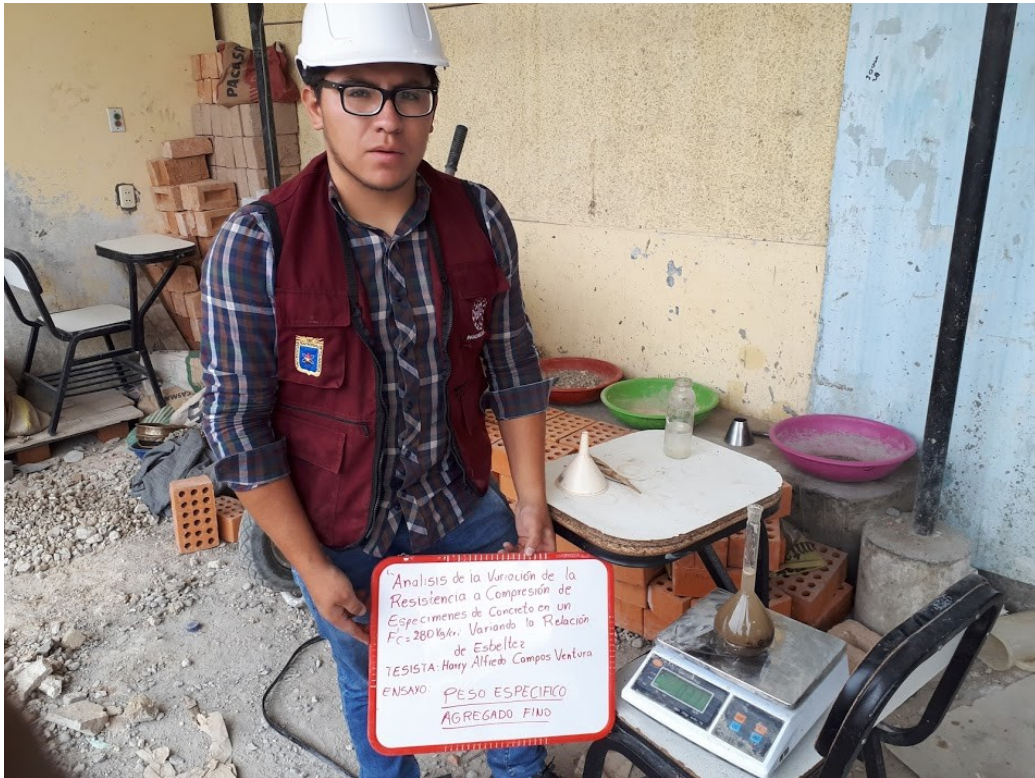
Figura 40. Ensayo para determinar el peso específico del agregado fino
