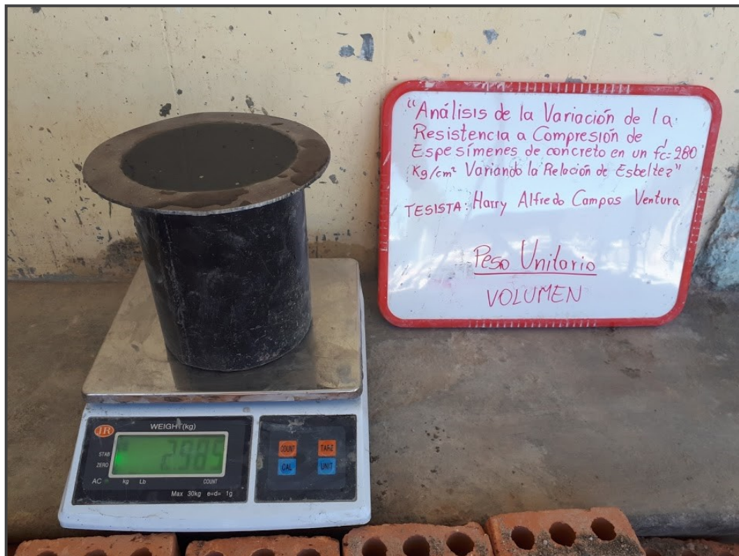
Figura 45. Calculo del volumen del recipiente empleado para determinar el peso unitario del agregado fino.
