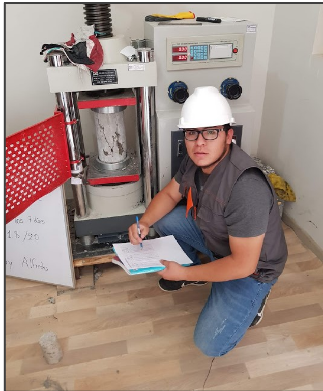
Figura 64. Registro de carga ultima de rotura en los especímenes cilíndricos
