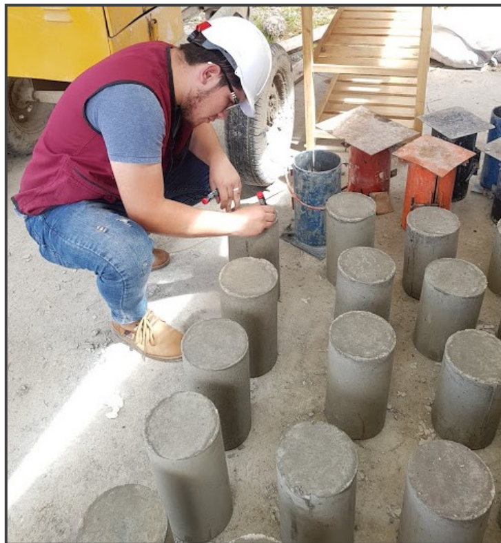
Figura 59. Desencofrado y codificación de los especímenes cilíndricos de concreto
