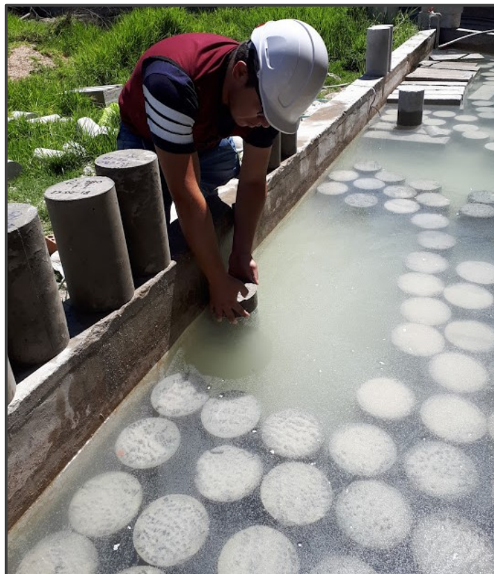
Figura 61. Curado de los especímenes cilíndricos de concreto
