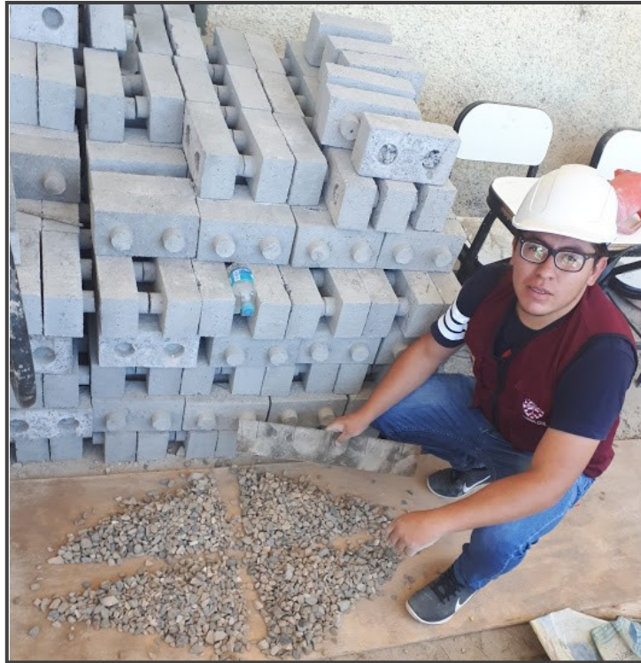
Figura 38. Cuarteo de los agregados para determinar sus diferentes propiedades físico-mecánicas
