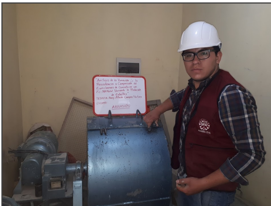
Figura 51. Máquina de los ángeles empleada para el ensayo de abrasión
