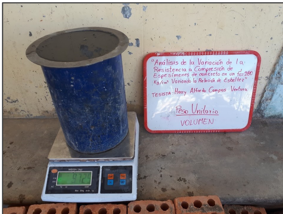
Figura 47. Calculo del volumen del recipiente empleado para determinar el peso unitario del agregado Grueso.
