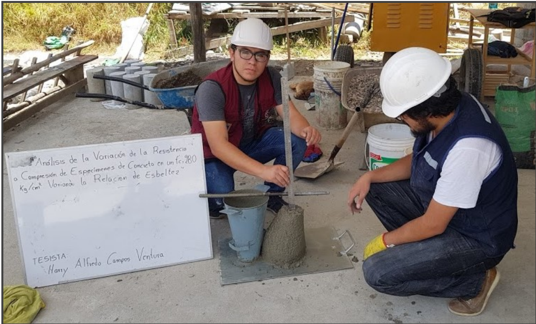
Figura 56. Ensayo de asentamiento de cono de Abrams
