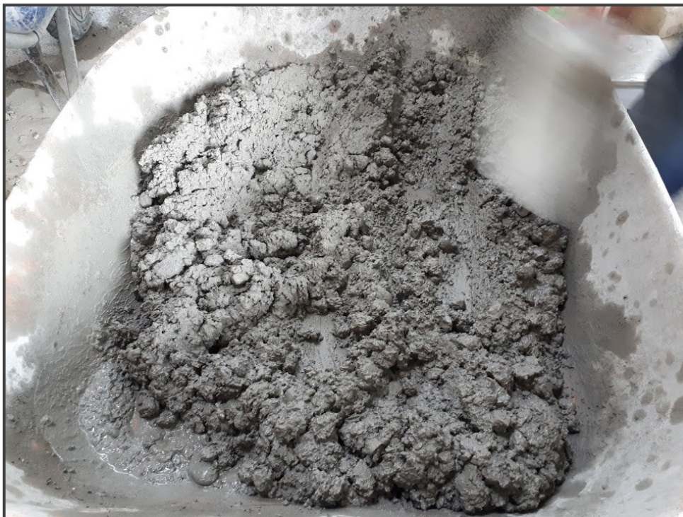
Figura 55. Mezcla de consistencia plástica elaborada para la fabricación de los especímenes de concreto con diferente esbeltez
