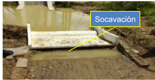
Figura 2. Modelamiento físico de estructura de captación. Para condición de prueba (izquierda); poza de erosión y socavación en estructura (derecha).
