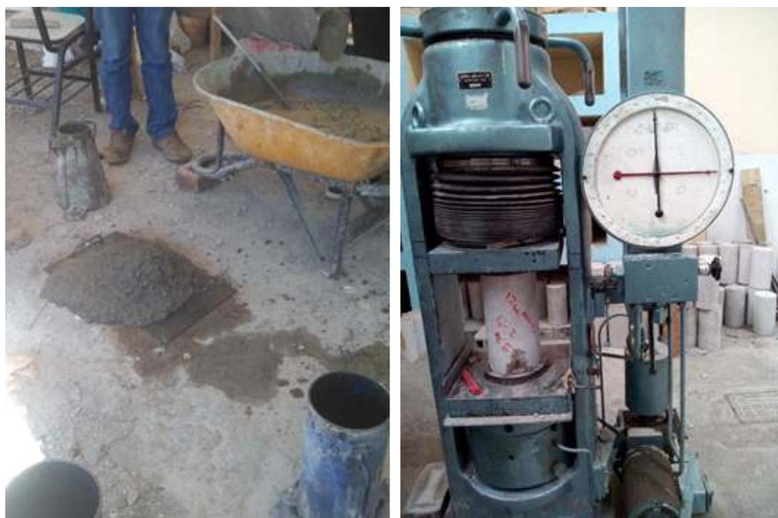
**Figura 3.** Ensayo de Cono de Abrams (izquierda), probeta sometida al ensayo de compresión axial (derecha).
