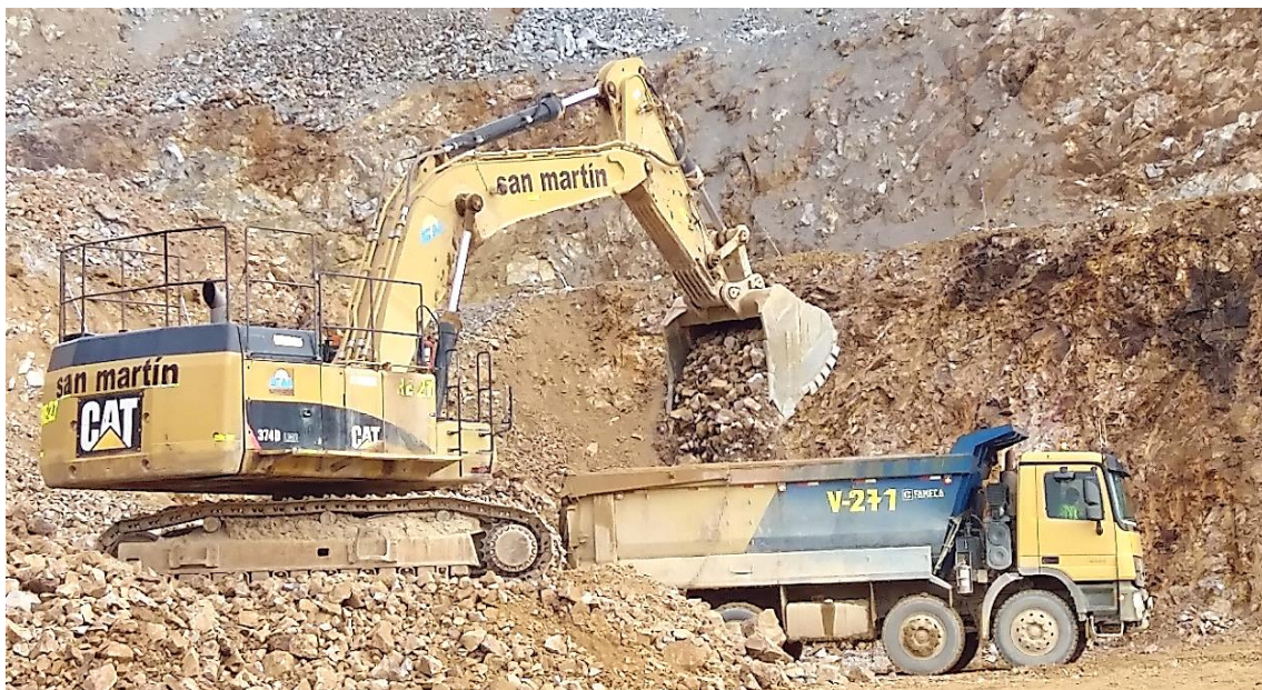
Foto 2. Proceso de Carguío (Excavadoras)
