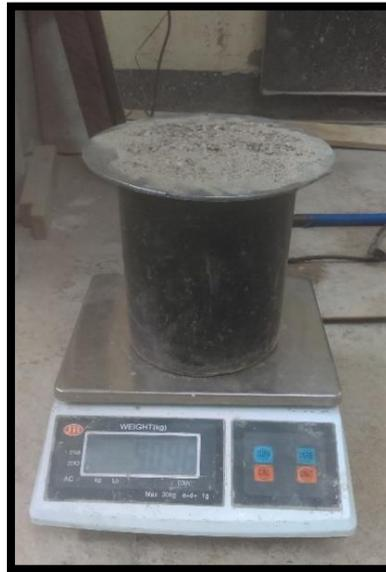
**Foto N ° 1:** Determinación del Peso unitario seco del agregado fino.
