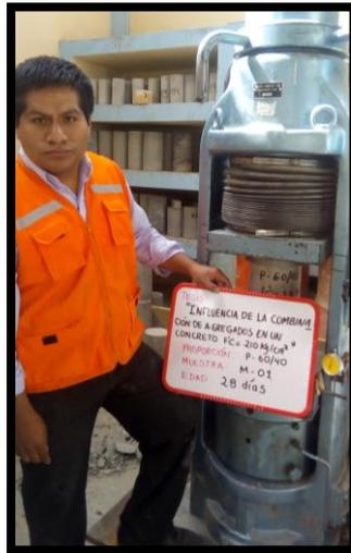
**Foto 9:** Ensayando una probeta de proporción 60/40 a los 28 días.
