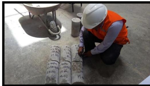
**Foto 10:** analizando el tipo de falla de la probeta ensayada.
