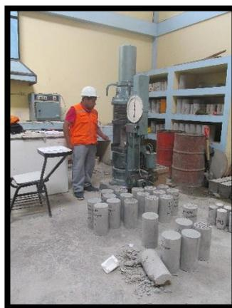
**Foto 11:** Probetas de concreto luego de ser ensayadas.
