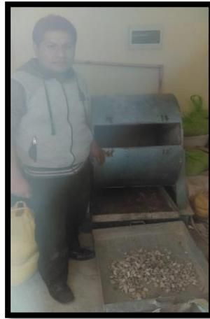
**Foto 4:** Máquina de los Ángeles para realizar el ensayo de Abrasión del agregado grueso.
