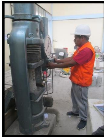
**Foto 7:** Realizando el ensayo a compresión de probetas cilíndricas en la Máquina Universal.
