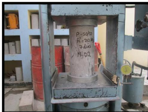
**Foto 8:** Sometiendo un espécimen al ensayo de compresión en la Máquina Universal.
