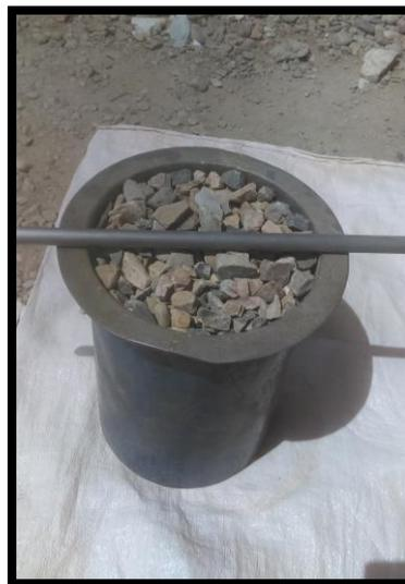
**Foto 2:** Enrase para determinación del Peso unitario seco compactado del agregado grueso.
