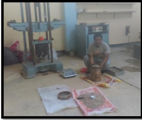
**Foto 3:** Realizando el ensayo de granulometría del agregado fino, utilizando los tamices estándar.
