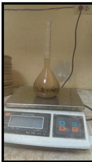
**Foto 5:** Realizando el ensayo de peso específico y absorción del agregado fino.
