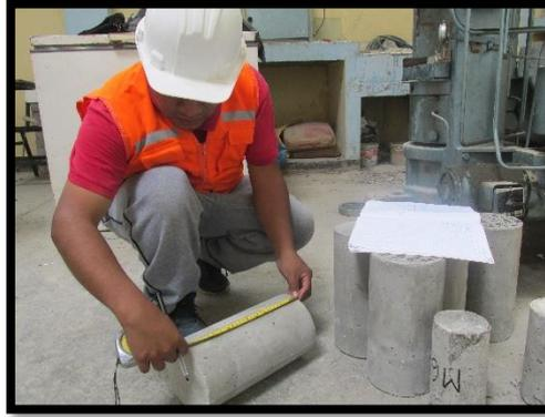
**Foto 6:** Tomando nota de las dimensiones de probetas cilíndricas de concreto endurecidas antes de ser ensayadas.
