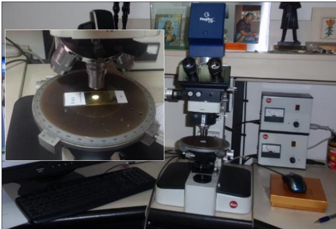
Foto 7. Microscópico óptico para estudio petrográfico – microtectónico
