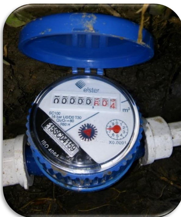
Fotografía 1: Medidor de agua doméstico modelo SC100, a utilizar en el estudio
