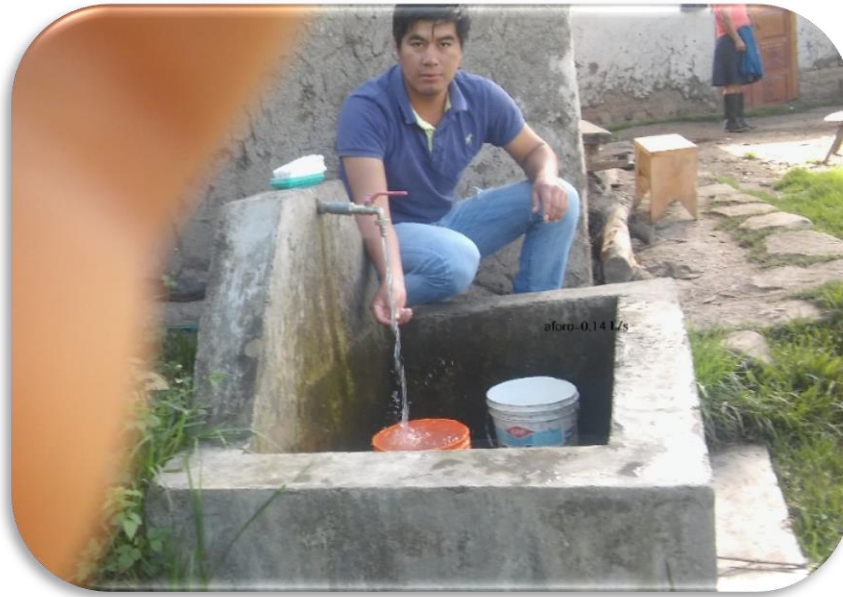
Fotografía 14: Aforo de lavadero multiusos-pileta por el método volumétrico
