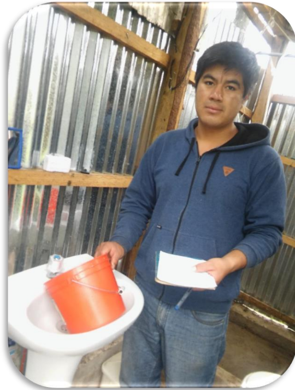
Fotografía 16: Aforo de lavatorio de manos por el método volumétrico
