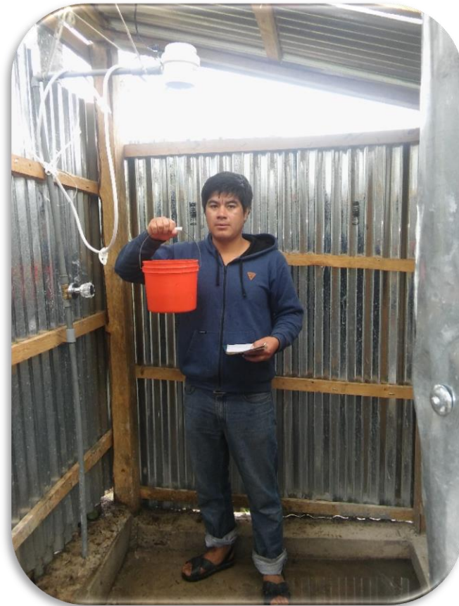
Fotografía 15: Aforo de ducha por el método volumétrico
