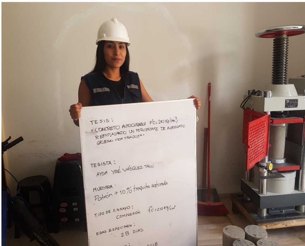
IMAGEN N°8: Fotografía del ensayo de rotura de especímenes cilíndricos de concreto
