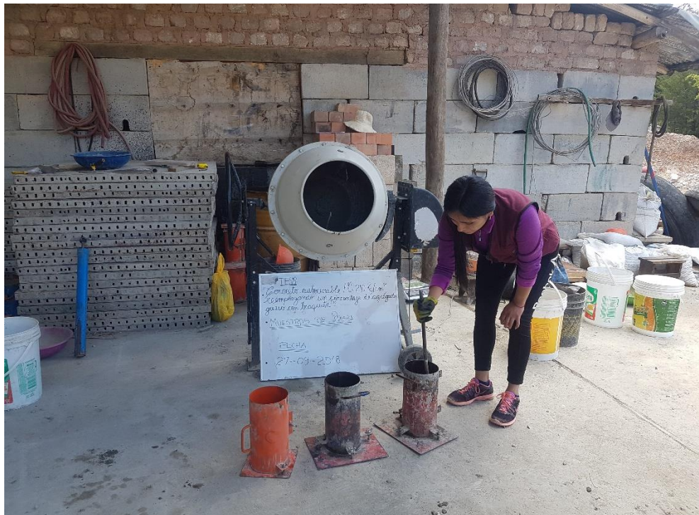
IMAGEN N°6: Fotografía realizando el apisonado para las muestras de prueba
