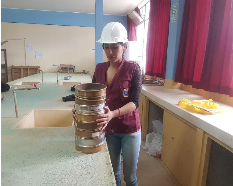
IMAGEN N°3: Fotografía realizando el ensayo de granulometría
