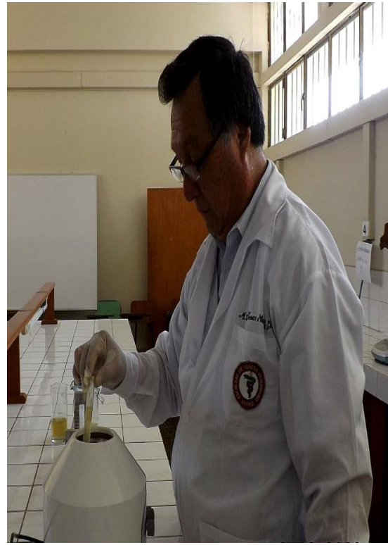
Fig. 6 Centrifugar el líquido con el sedimento.
