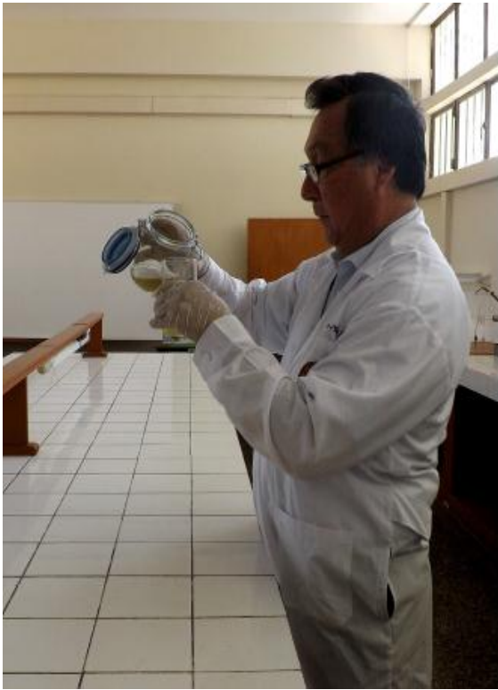
Fig. 5 Vaciar el exceso del líquido sobrenadante.
