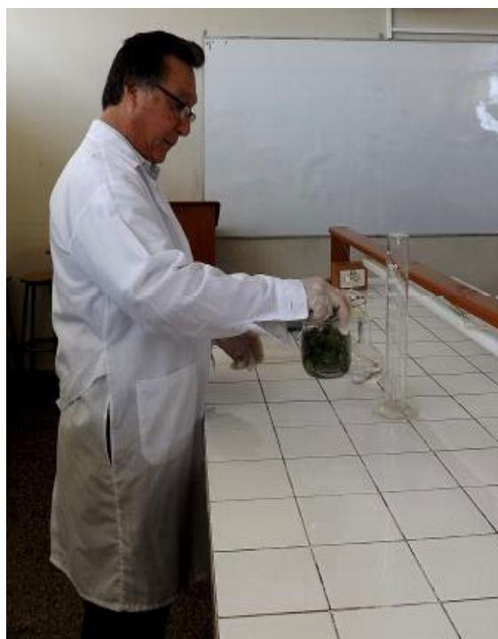
Fig. 4 Agitar el frasco para lavar y dejar reposar por seis horas.
