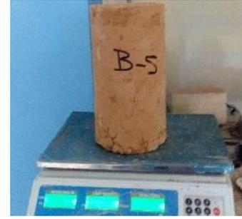
**Foto 32** : Toma de peso del espécimen de adobe a tracción.
