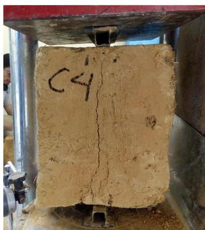
Figura 76: Ensayo del mortero a la tracción (tipo C).
