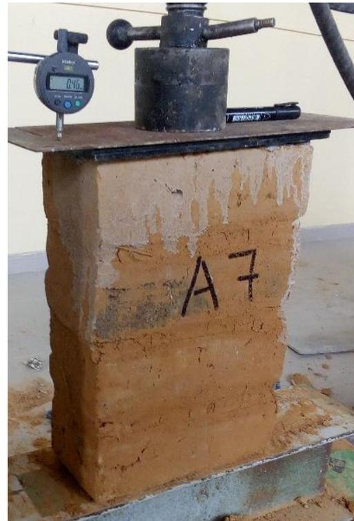
**Foto 43** : Ensayo del murete a compresión.
