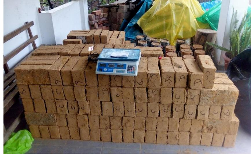
**Foto 18** : Apilado y proceso de secado de adobes, bajo techo.
