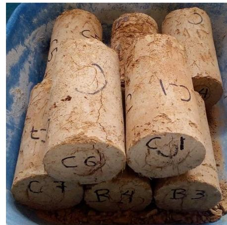
Figura 61: Estado del espécimen de adobe tipo B, C y D después del ensayo a tracción.
