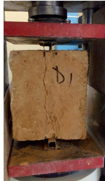
**Foto 41** : Ensayo del mortero a la tracción
