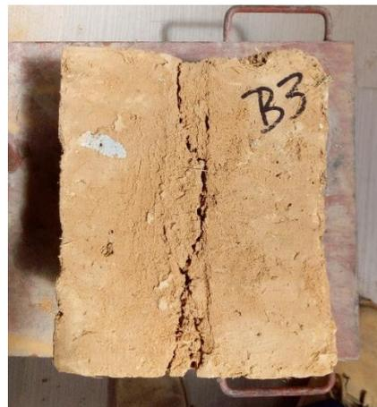
Figura 79: Estado del espécimen después del ensayo del mortero a la tracción (tipo B).
