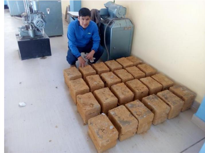
**Foto 27** : Especímenes de adobe para el ensayo a tracción del mortero.
