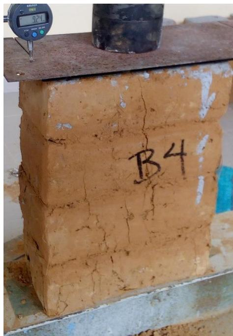
Figura 84: Murete de adobe tipo B, durante del ensayo a compresión.
