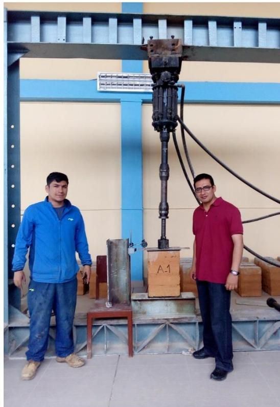
**Foto 47** : Presencia del asesor durante el ensayo a compresión del murete.
