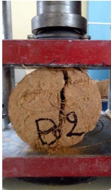
**Foto 40** : Ensayo a la tracción del adobe.
