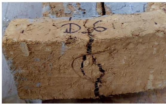
Figura 70: Estado del espécimen después del ensayo a la flexión (tipo D).
