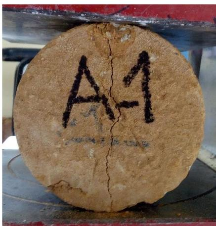
Figura 56: Ensayo a la tracción del adobe (tipo A).
