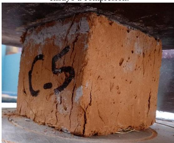
Figura 51: Cubo de adobe tipo C, durante el ensayo a compresión.
