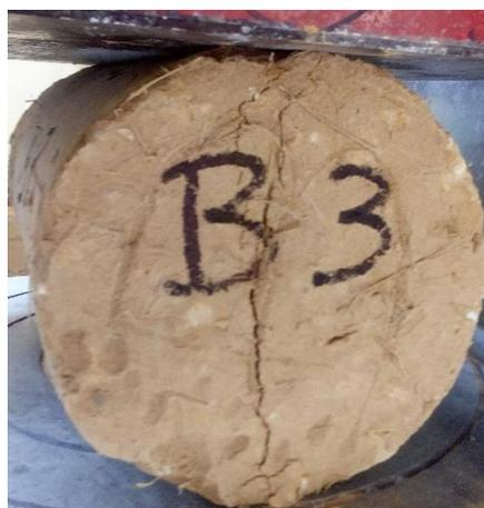
Figura 57: Ensayo a la tracción del adobe (tipo B).
