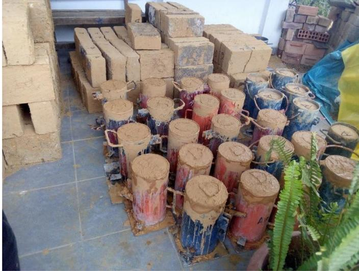
**Foto 17** : Proceso de secado de los adobes para ensayo a tracción.
