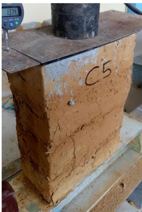
Figura 85: Murete de adobe tipo C, durante del ensayo a compresión.
