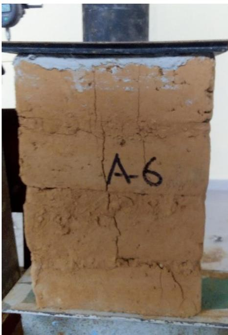
Figura 83: Murete de adobe tipo A, durante del ensayo a compresión.
