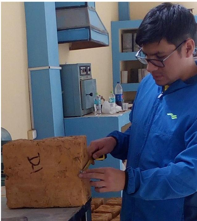
**Foto 36** : Toma de medidas del espécimen a tracción del mortero de adobe.
