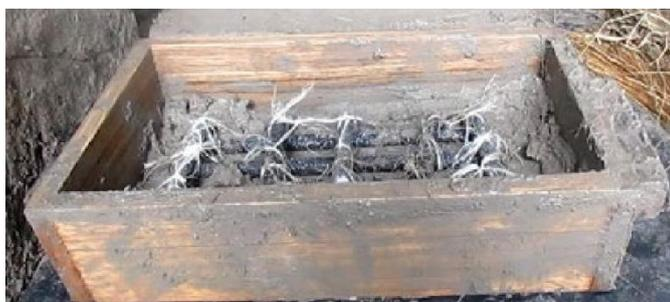
Figura 6: Ubicación de las varillas de fibra de vidrio en el adobe.
