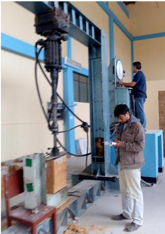
**Foto 46** : Toma de deformación y carga del ensayo a compresión del murete.
