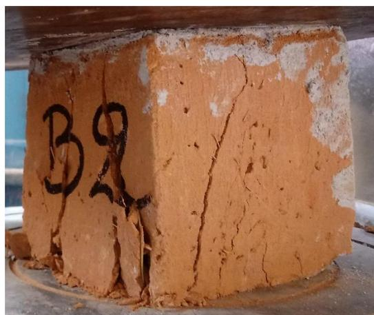
Figura 50: Cubo de adobe tipo B, durante el ensayo a compresión.
