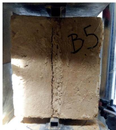
Figura 75: Ensayo del mortero a la tracción (tipo B).
