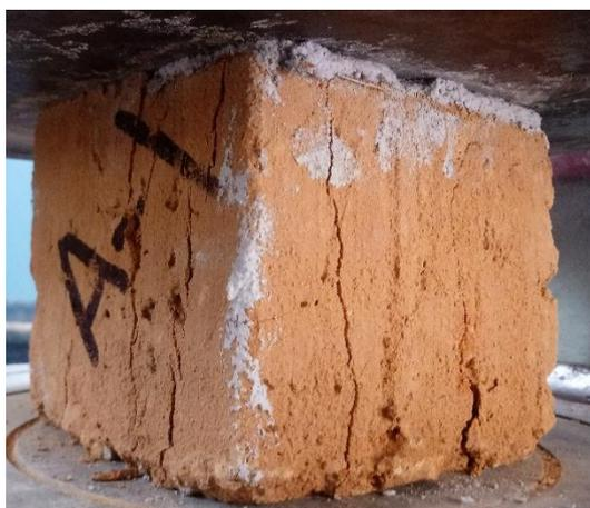
Figura 49: Cubo de adobe tipo A, durante el ensayo a compresión.
