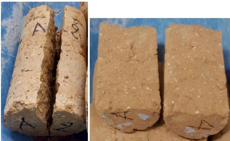
Figura 60: Estado del espécimen de adobe tipo A, después del ensayo a tracción.
