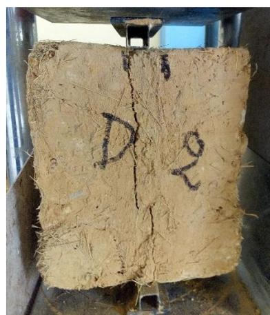
Figura 77: Ensayo del mortero a la tracción (tipo D).
