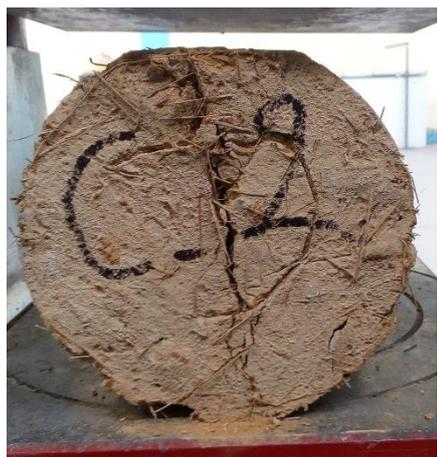
Figura 58: Ensayo a la tracción del adobe (tipo C).
