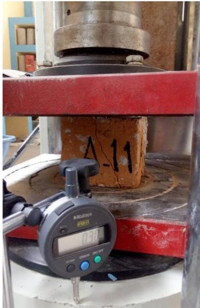
**Foto 39** : Ensayo a compresión de la unidad de adobe (cubo).
