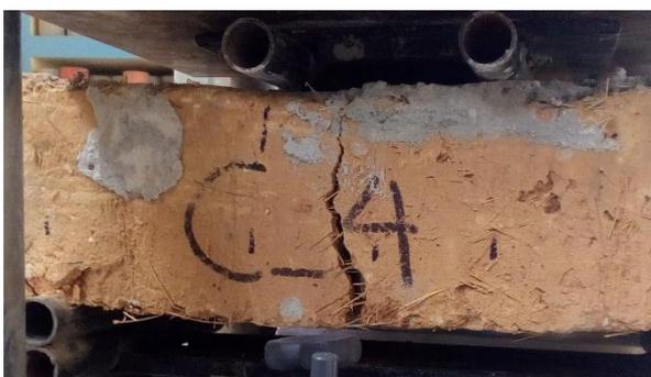
Figura 67: Ensayo del adobe a la flexión (tipo C).
