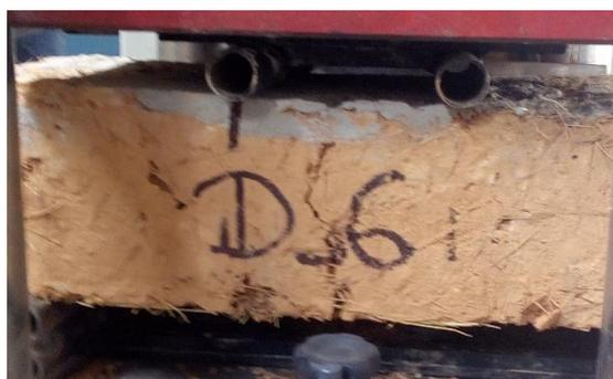
Figura 68: Ensayo del adobe a la flexión (tipo D).
