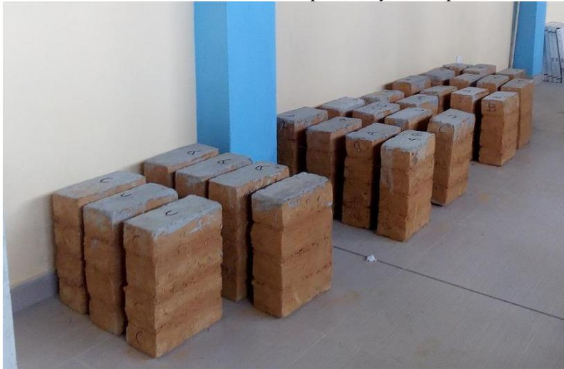
**Foto 28** : Muretes de adobe para el ensayo a compresión.
