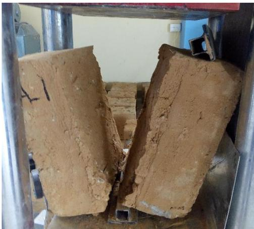
Figura 78: Estado del espécimen después del ensayo del mortero a la tracción (tipo A).
