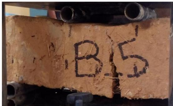
Figura 66: Ensayo del adobe a la flexión (tipo B).
