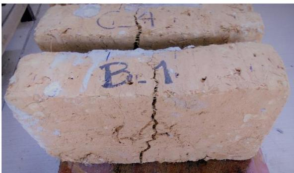
Figura 69: Estado del espécimen después del ensayo a la flexión (tipo B y C).
