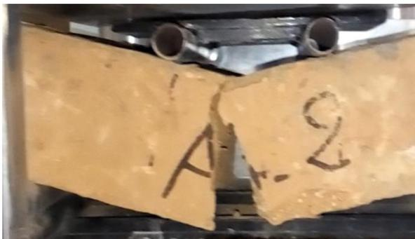
Figura 65: Ensayo del adobe a la flexión (tipo A).
