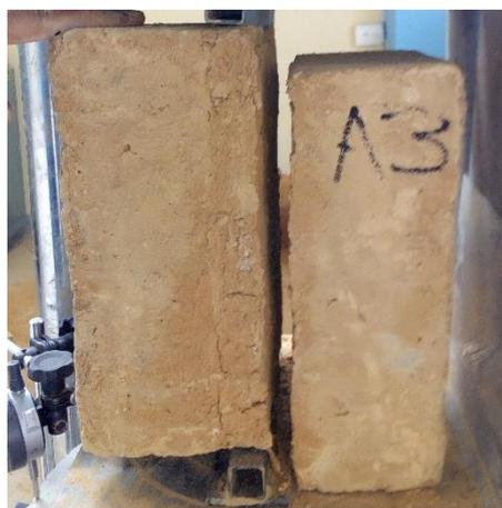
Figura 74: Ensayo del mortero a la tracción (tipo A).
