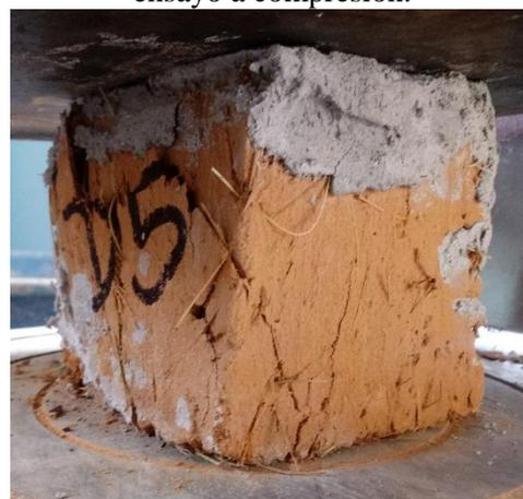
Figura 52: Cubo de adobe tipo D, durante el ensayo a compresión.
