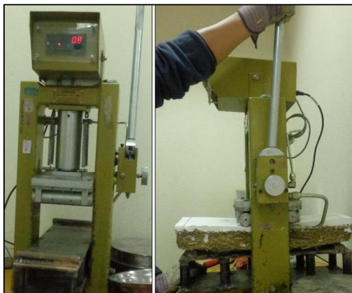
Figura 20: Carga a velocidad constante con el equipo de resistencia a la flexión.
