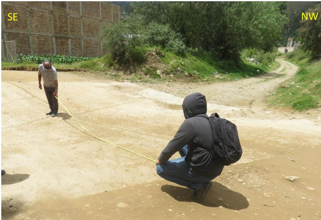
Figura 50. Este badén que se logra apreciar tiene una orientación N145°S, con una Pendiente de 6° por sus medidas se logró identificar que es el más ancho respecto a los vistos anteriormente.
