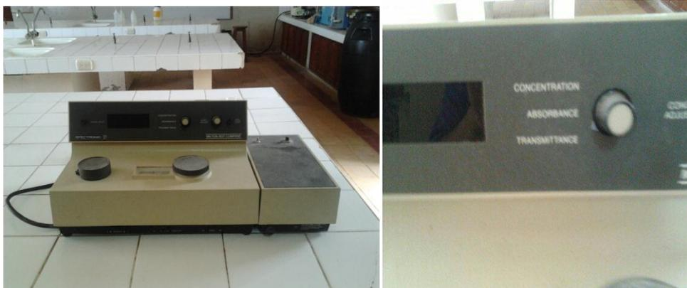
Fig. 16. Determinación de la absorbancia. Espectrofotómetro
