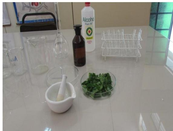
Fig. 12. Acondicionamiento muestra para determinación contenido fenoles
