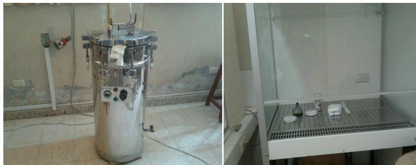
Figura 19. Equipos: Autoclave y cámara de flujo laminar
