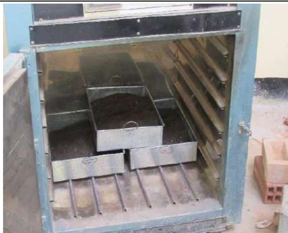
**Figura 81.** Muestras en la estufa para ensayo de contenido de humedad
