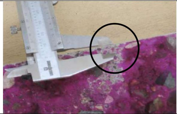
**Figura 108.** Determinación de la profundidad de carbonatación en los 6 puntos propuestos
