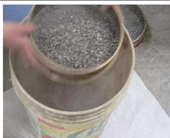
**Figura 84.** Determinación de la granulometría de los agregados.
