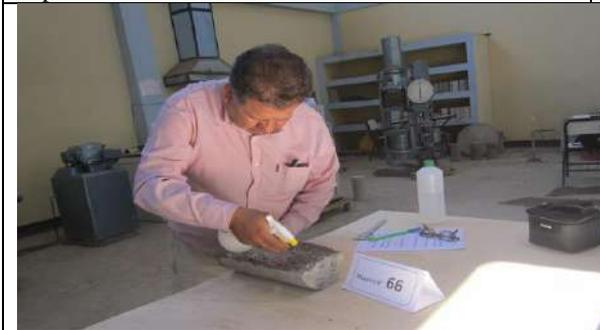
**Figura 102.** Aplicación de la fenolftaleína para muestras expuestas 60 días a CO<sub>2</sub>
