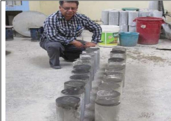
**Figura 100.** Medición e identificación de muestras a exponer 60 días a CO<sub>2</sub>
