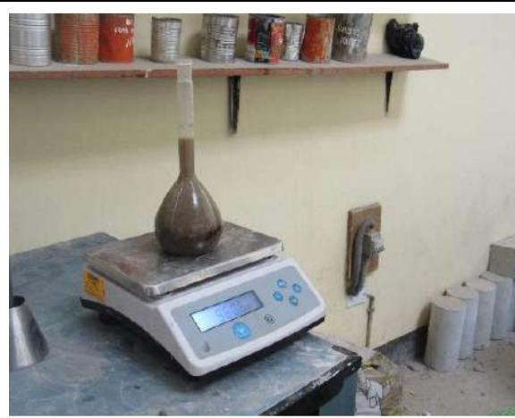
**Figura 86.** Ensayo de peso específico y absorción del agregado fino.
