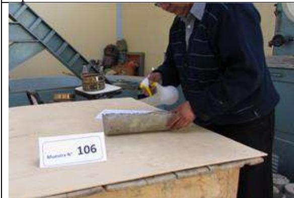
**Figura 112.** Aplicación de la fenolftaleína para muestras expuestas 90 días a CO<sub>2</sub>
