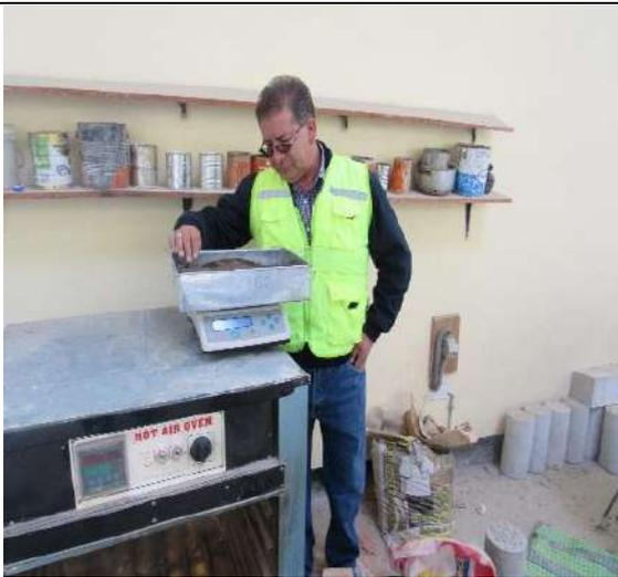
**Figura 79.** Peso de muestra para ensayo de contenido de Humedad.
