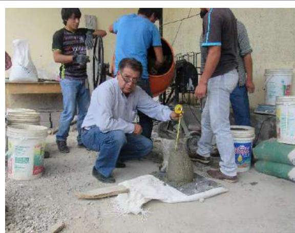
**Figura 88.** Chequeo del slump del concreto para elaboración de muestras
