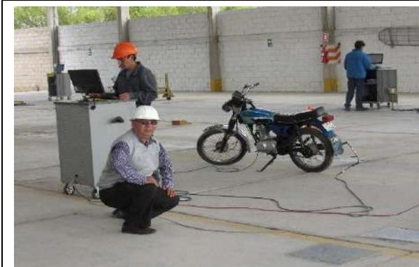
**Figura 106.** Medición de la cantidad de gases emitidos por el motor de la moto lineal
