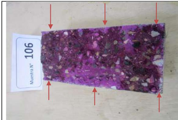
**Figura 114.** La profundidad de carbonatación de muestras recubiertas con aditivo expuestas 120 días a  $\text{CO}_2$ , muestran carbonatación en los bordes
