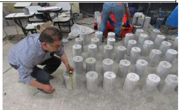
**Figura 92.** Registro del diámetro, altura, peso de probetas cilíndricas de concreto, antes del ensayo
