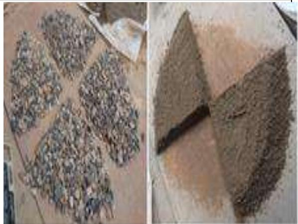
**Figura 78.** Reducción de muestras mediante el método del cuarteo
