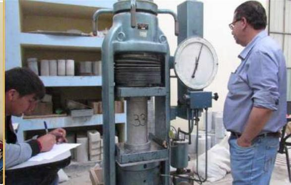
**Figura 96.** Ensayo a compresión axial de muestras expuestas 30 días a CO<sub>2</sub>
