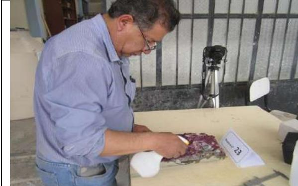
**Figura 97.** Aplicación de la fenolftaleína para el test de profundidad de carbonatación
