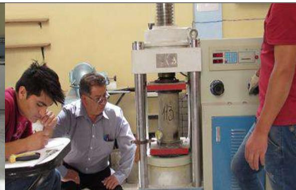
**Figura 111.** Ensayo a compresión axial de muestras expuestas 60 días a CO<sub>2</sub>
