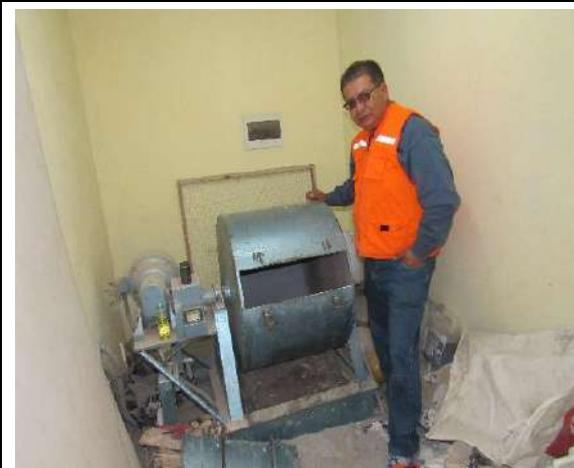
**Figura 85.** Ensayo de Abrasión.
