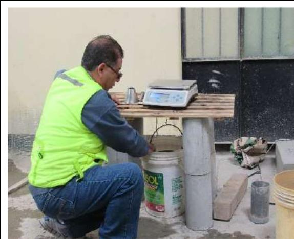
**Figura 83.** Peso sumergido de la grava, ensayo peso específico y absorción.
