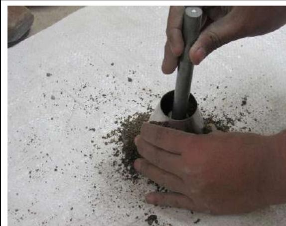
**Figura 87.** Ensayo de determinación de la condición saturada superficialmente seca (SSS) de la arena para el ensayo de peso específico y absorción
