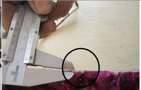
**Figura 98.** Determinación de la profundidad de carbonatación en los 6 puntos propuestos
