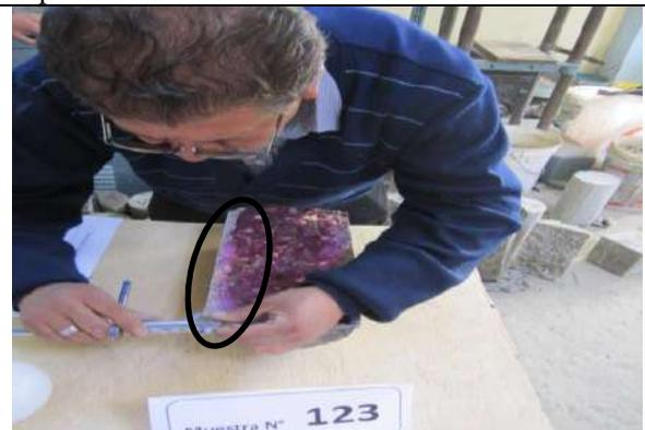
**Figura 113.** Determinación de la profundidad de carbonatación en los 6 puntos propuestos
