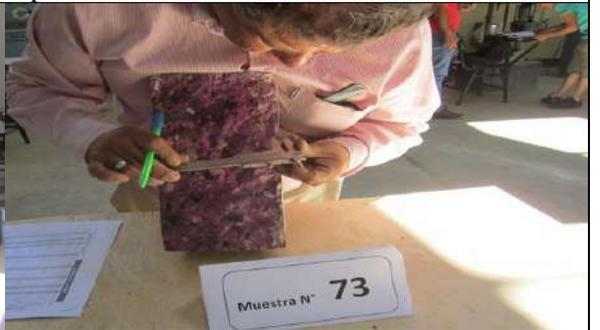
**Figura 103.** Determinación de la profundidad de carbonatación en los 6 puntos propuestos
