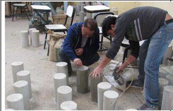
**Figura 95.** Aplicación y verificación del espesor de lámina del recubrimiento con aditivo Chema Seal® y
