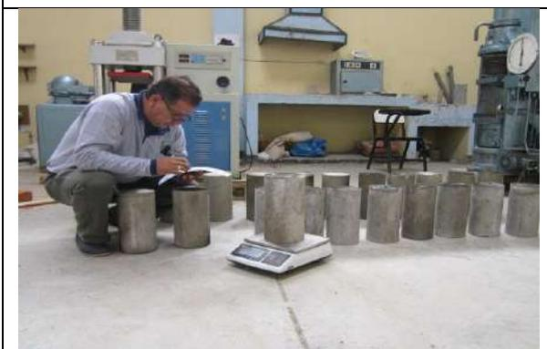
**Figura 105.** Medición e identificación de muestras a exponer 90 días a CO<sub>2</sub>
