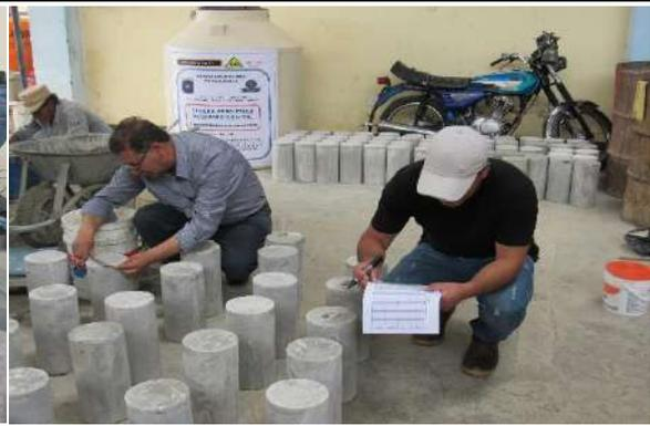
**Figura 109.** Medición e identificación de muestras a exponer 30 días a CO<sub>2</sub>
