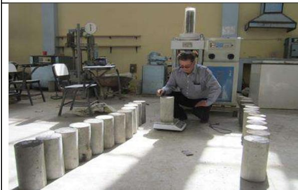
**Figura 110.** Medición e identificación de muestras expuestas 120 días a CO<sub>2</sub>
