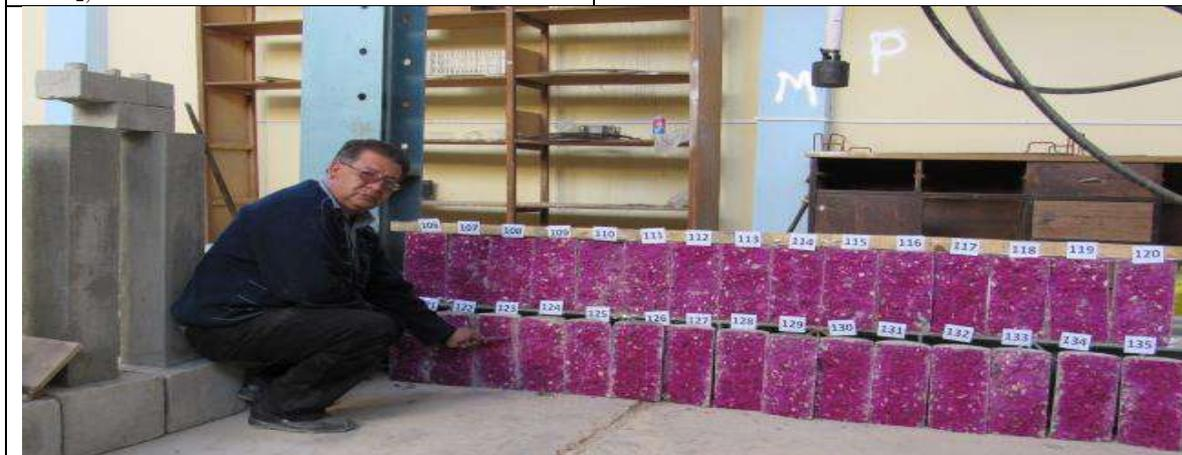
**Figura 116.** Tercer lote de 30 muestras expuestas al  $\text{CO}_2$  120 días, con y sin aditivo
