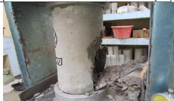
**Figura 105.** Ilustra una de las fallas producidas en las muestras patrón
