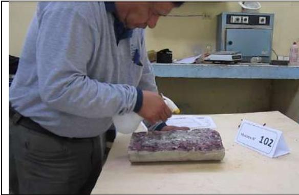
**Figura 107.** Aplicación de la fenolftaleína para muestras expuestas 90 días a CO<sub>2</sub>
