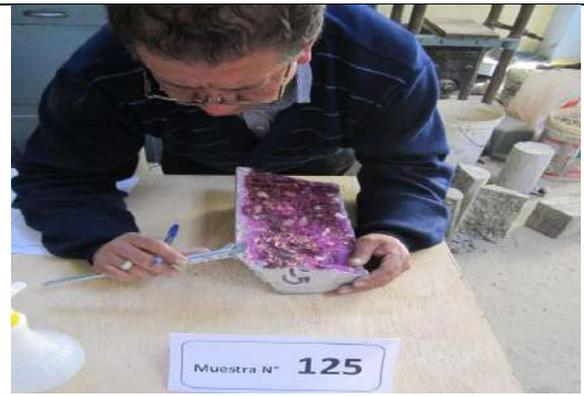
**Figura 115.** La profundidad de carbonatación de muestras sin recubrimiento expuestas 120 días a  $\text{CO}_2$ , muestran carbonatación avanzada
