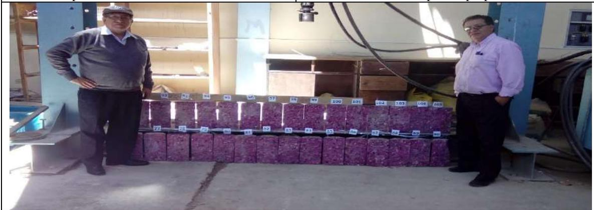
**Figura 109.** Tercer lote de 30 muestras expuestas al CO<sub>2</sub> 90 días, con y sin aditivo
