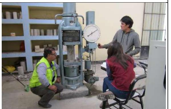
**Figura 106.** Ensayo a compresión axial de muestras expuestas 90 días a CO<sub>2</sub>
