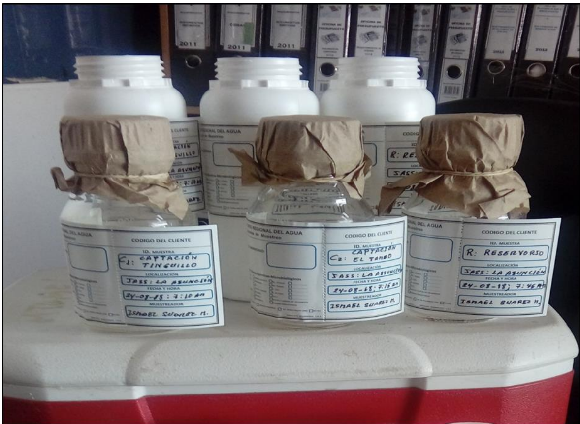
Figura 21. Recipientes para muestreos fisicoquímicos y bacteriológicos.
