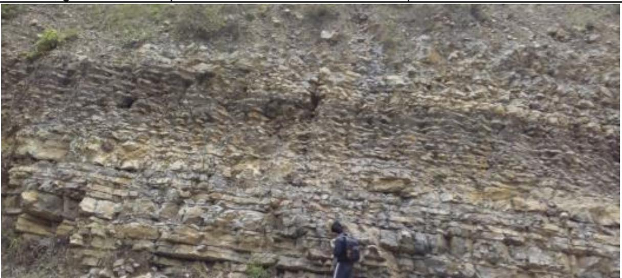
Foto 20: Afloramiento de calizas bituminosas en estratificación delgada de la Formación Pariatambo (Ki - Pa), en las progresivas Km 128+195 - Km 128+235.
