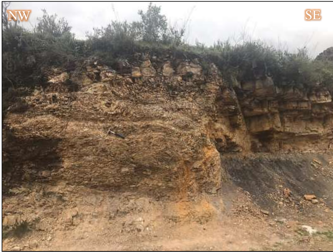
Foto N° 13. Talud de estación N° 03, evidenciándose lutitas y areniscas calcáreas ferruginosas, altamente meteorizadas.
