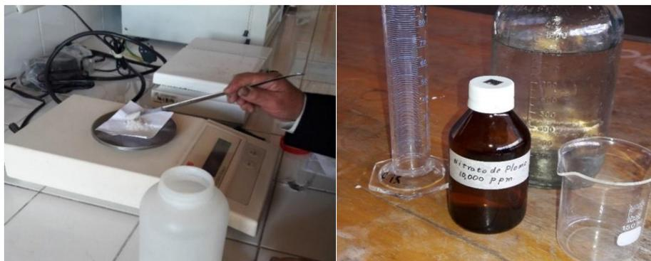
**Figura 3.** Preparación de la solución nitrato de plomo  $[Pb(NO_3)_2]$  de 10,000 ppm de concentración.
