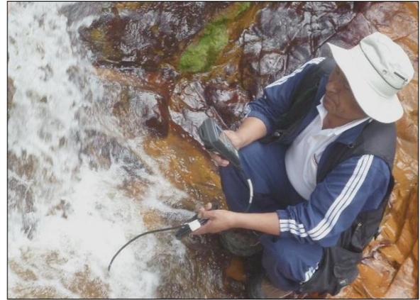
Figura 54. Se observa el muestreo de agua ácida en MP-1 y la determinación del pH. en la Qda. de Pozo Ricos- Corona, ubicado en la intersección de la trocha carrozable a Hualgayoc, Pozo Ricos -las Coloradas.
