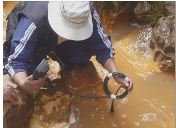
Figura 55. Se aprecia muestreo de agua ácida en MP-2 y la determinación del pH. con Peachímetro digital con protocolo establecido; en la Qda. C<sup>o</sup> Jesús -Hualgayoc.
