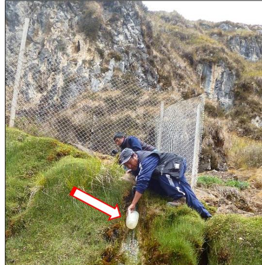
Figura 71: Determinación del volumen por el método volumétrico en los puntos MP-1 Qda. Pozo Ricos -Corona (Izq.) y MP-4 Bocamina la Zarza (Dech.)
