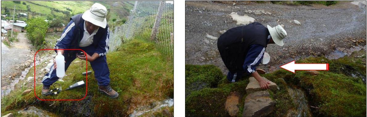
Figura 70. Monitoreo de agua, medida del pH (digital) y determinación del volumen por el método volumétrico en el punto MP-4 afluente de la Bocamina la Zarza.
