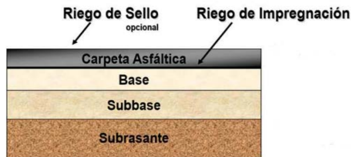
Figura 2: Estructura de un pavimento flexible.
