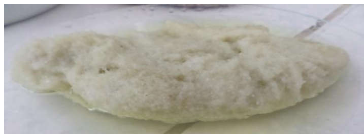
Figura 20: Separación de sólidos en suspensión en un líquido, mediante un lienzo.
