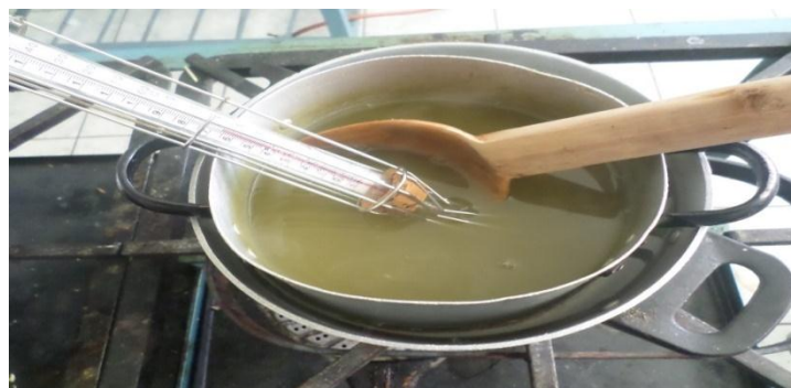
Figura 18: Concentración en un 20 % de su volumen a 65 °C
