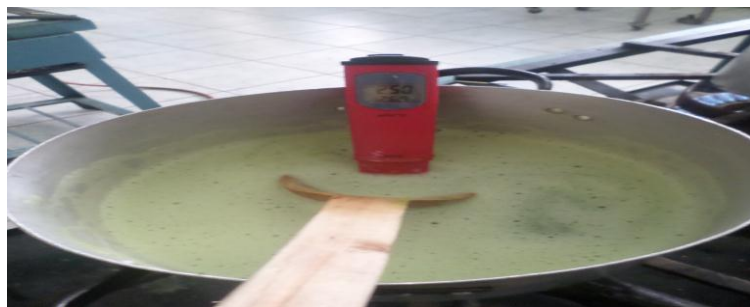
Figura 15: Concentración del nopal triturado a pH 2,5 con ácido cítrico ( C_6H_8O_7 )
