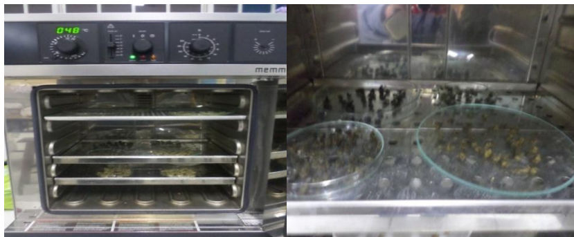
Figura 21: Secado a 40 \pm 5 °C por 12 horas Figura 22: Fin de secado
