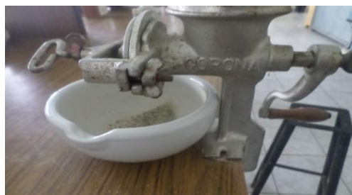
Figura 22: Molienda es la pulverización de las hojuelas obtenidas del horno
