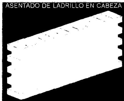
Fig.1.48 Asentado del ladrillo en cabeza
