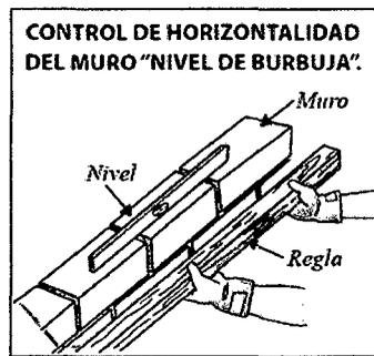
Fig.1.40 Control de la horizontalidad del muro
