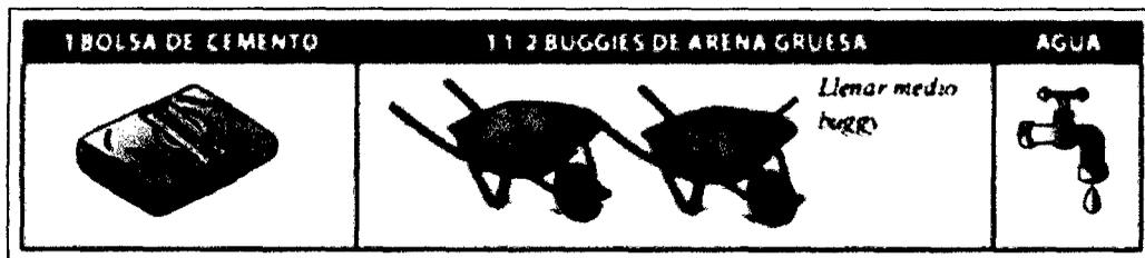
Fig.1.102 Dosificación adecuada para evitar los morteros mal preparados
