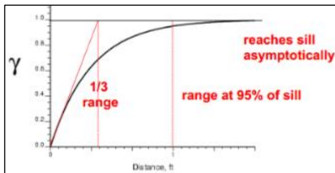
Figura N° 13: Variograma exponencial, donde “nugget variance” = 0. Similar a la esférica, pero se eleva más abruptamente y llega al “sill” asintóticamente.
