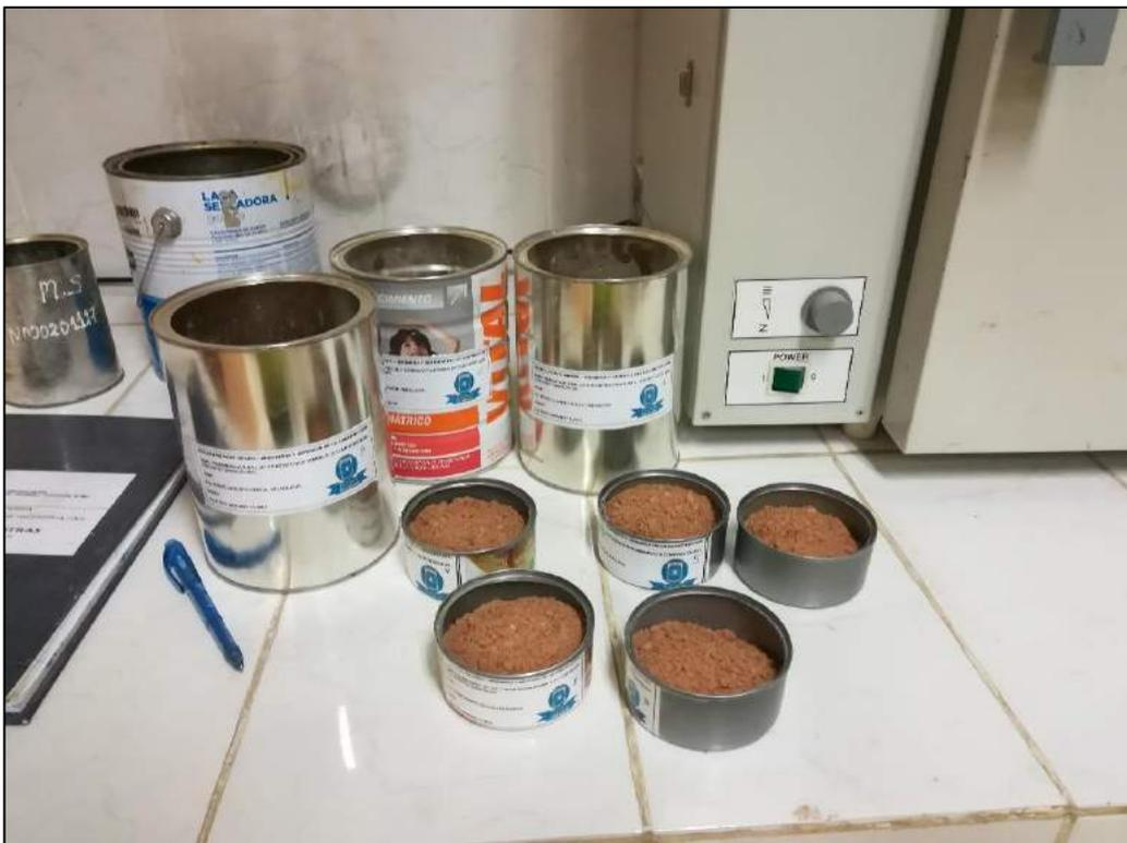
**Figura 21: Arena fina previamente pesadas y registradas colocadas en taras para secarlas en un horno**
