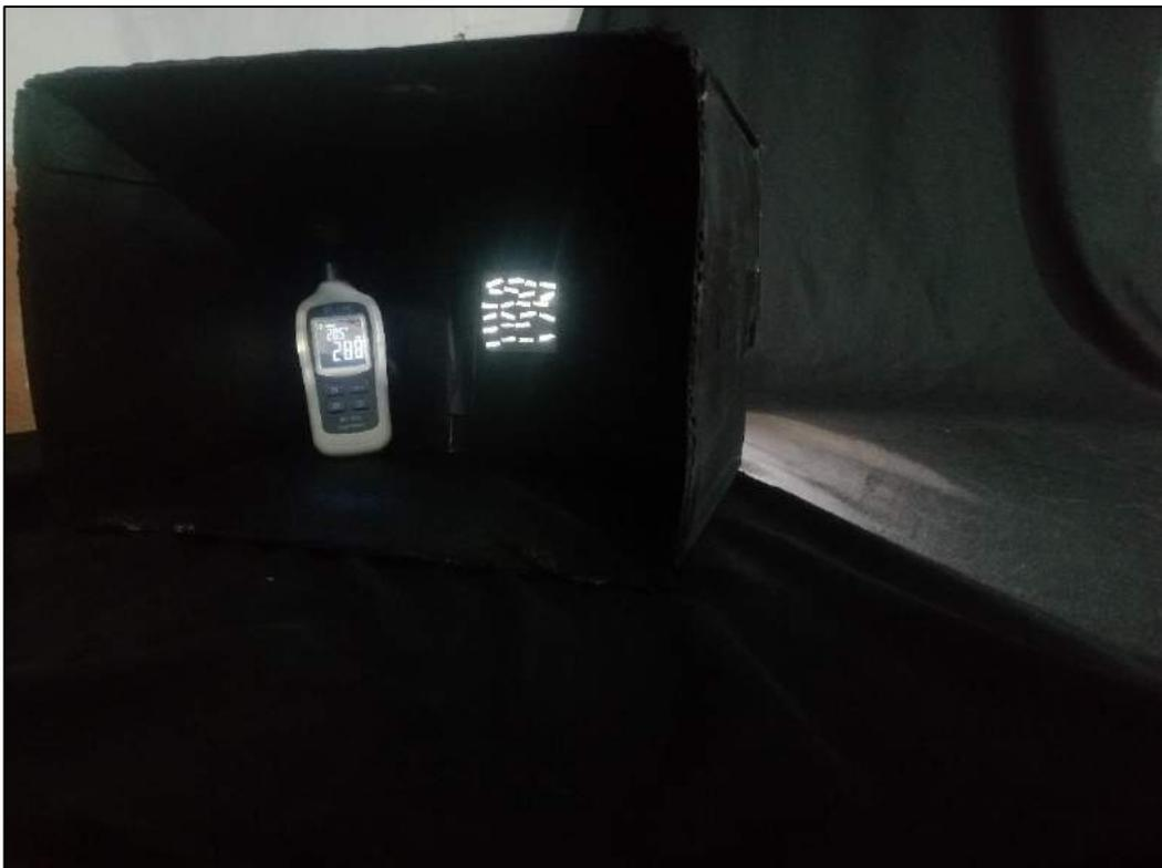
**Figura 33: Especímen transmitiendo la luz que atraviesa al bloque mismo**
