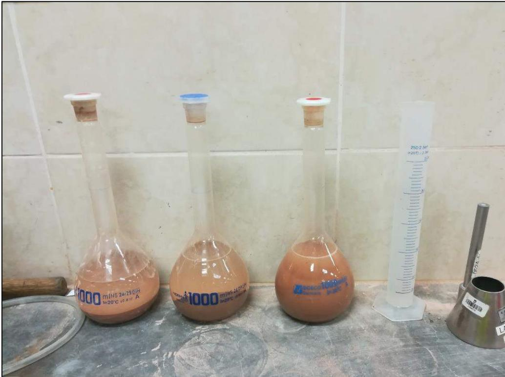
**Figura 20: Uso de tres fiolas para determinar las características de la arena fina como son densidad, contenido de humedad y absorción**
