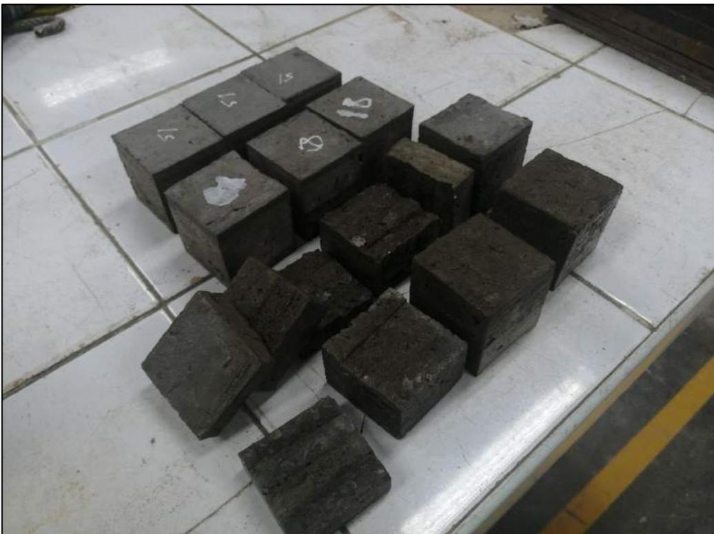
**Figura 29: Especímenes aptos y no aptos para someterlos ante una maquina universal para determinar su resistencia a la compresión**
