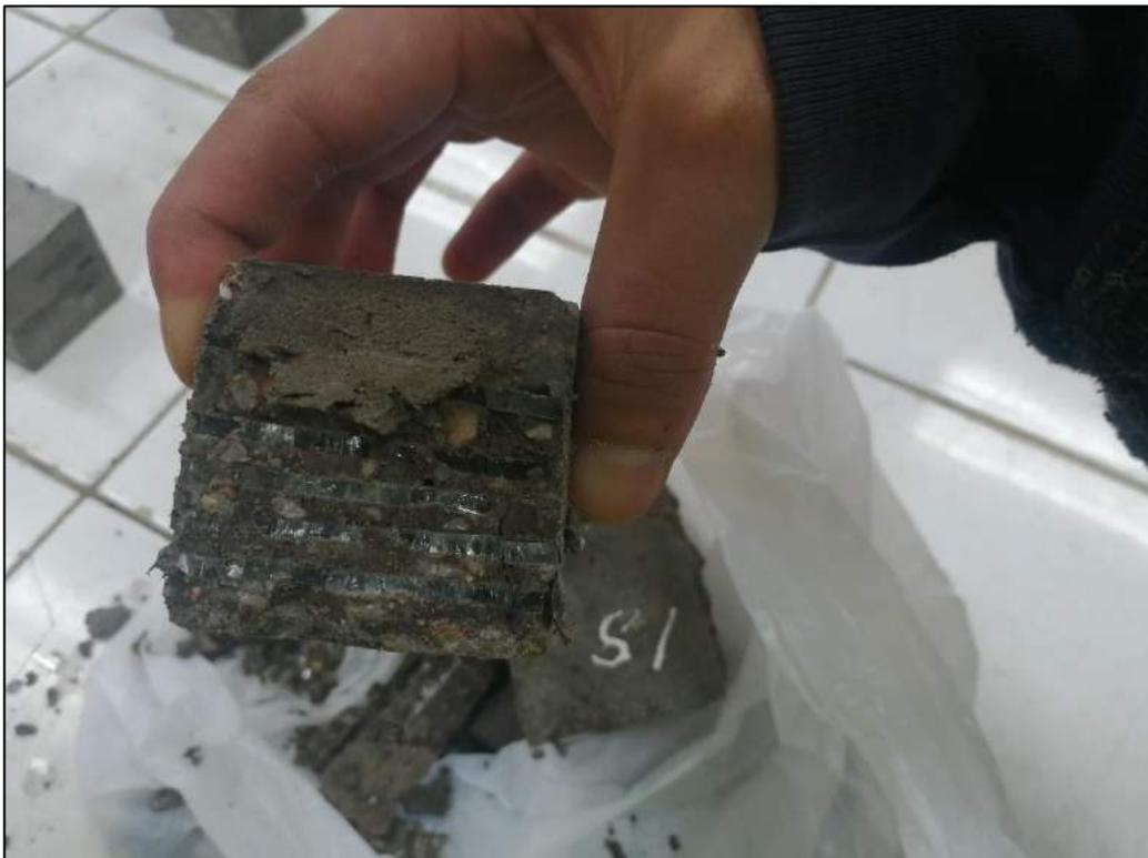
**Figura 31: Vista del vidrio en el interior de un espécimen sometido a compresión**
