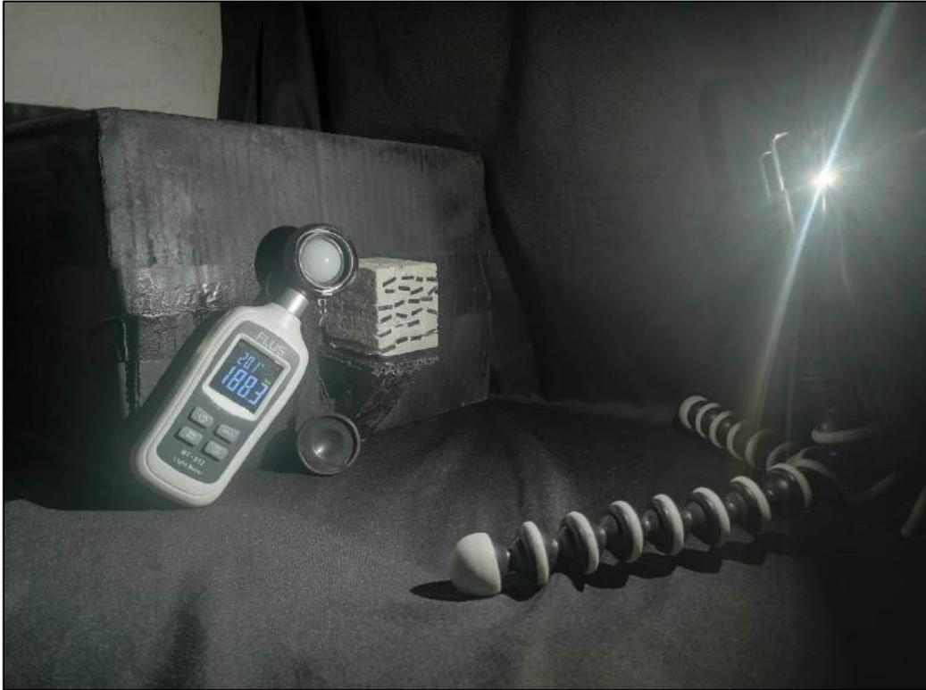
**Figura 32: Especímen recibiendo una intensidad de luz siendo medido por un luxómetro**
