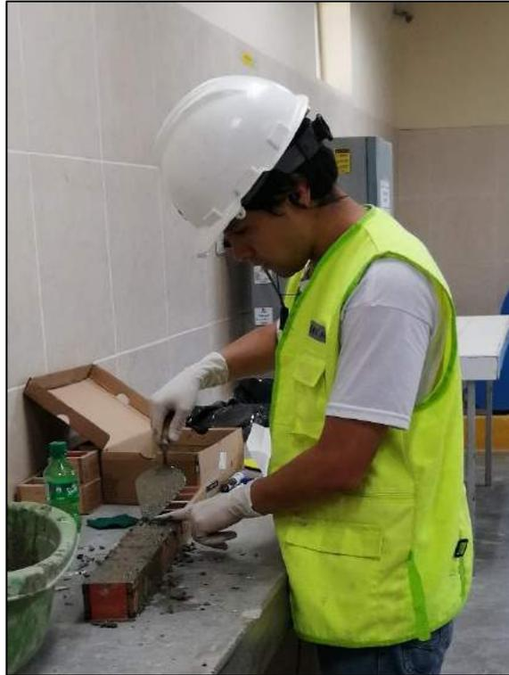
**Figura 26: Tesista fabricando los especímenes de concreto translúcido**
