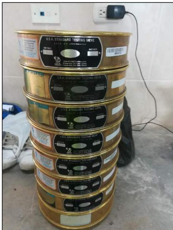
**Figura 23: Tamices utilizados para determinar el módulo de finura de la arena**
