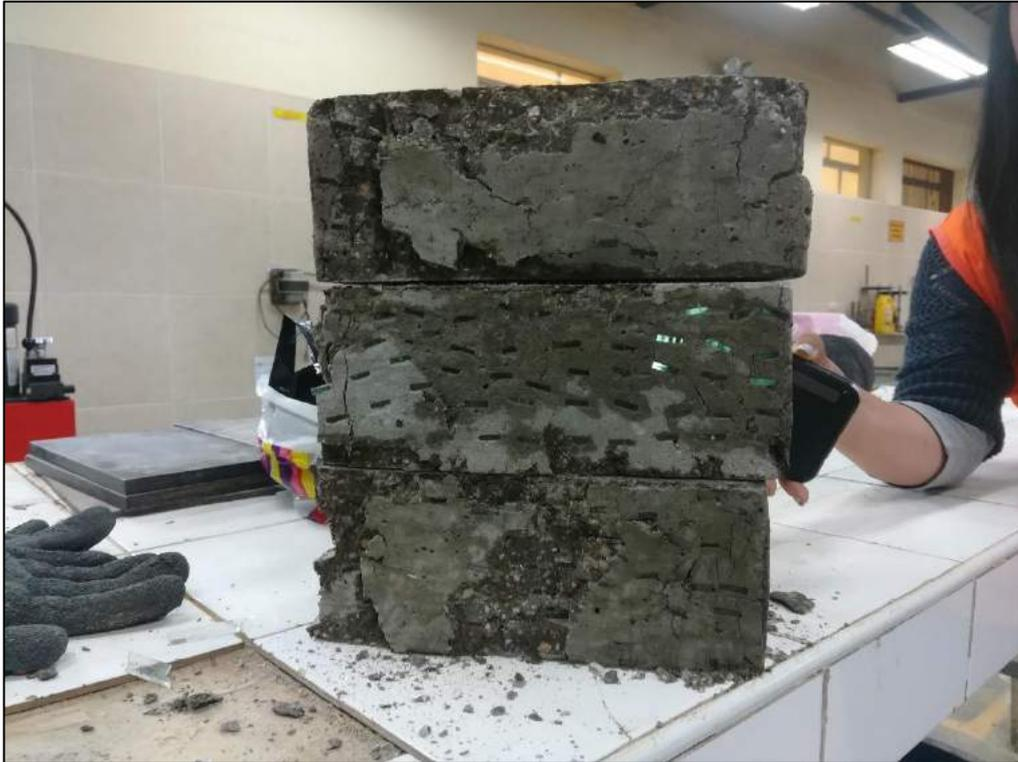
**Figura 16: Especímenes de concreto translúcido con medidas de 23 cm x 12 cm x 9 cm sometidos a compresión a los 7 días**
