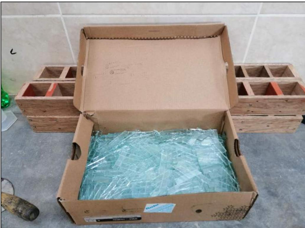
**Figura 25: Tiras de vidrio de 3 mm de espesor cortadas en 5 cm x 1 cm**
