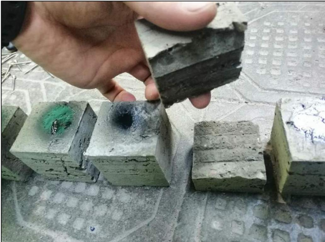
**Figura 27: Especímenes con 4 tiras de vidrio por fila descartados por no mantenerse en un solo conjunto al momento de desencofrarlos**
