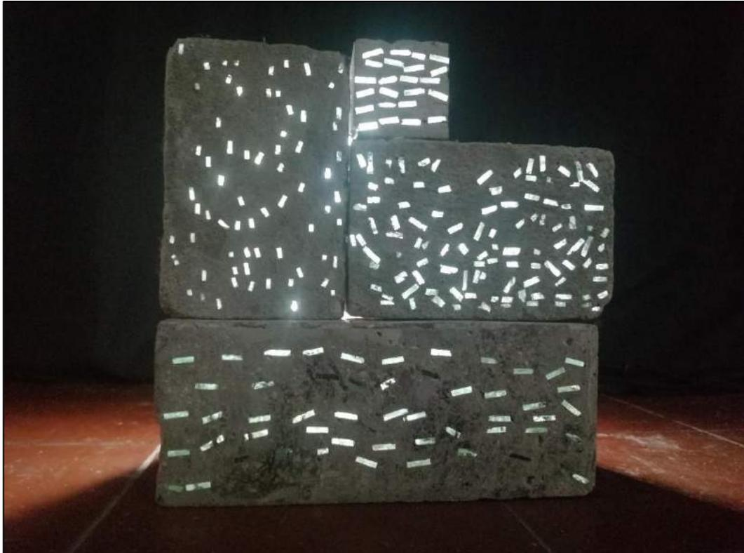
**Figura 37: Diferentes concretos translúcidos expuestos a la luz en su cara posterior**
