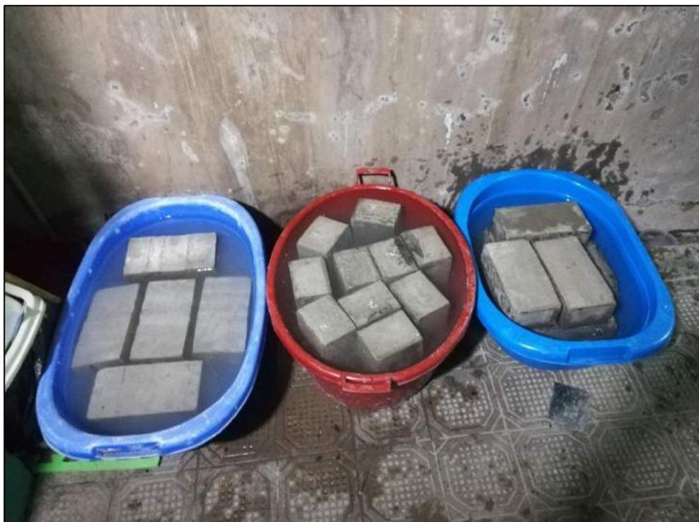
**Figura 13: Curado de los especímenes por inmersión de los concreto con medidas de 23 cm x 12 cm x 9 cm**
