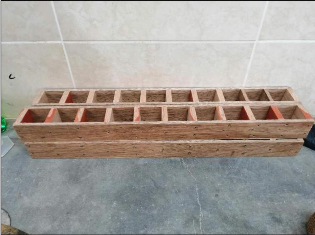
**Figura 24: Gaveras de madera para especímenes de concreto de 5 cm x 5 cm x 5 cm**
