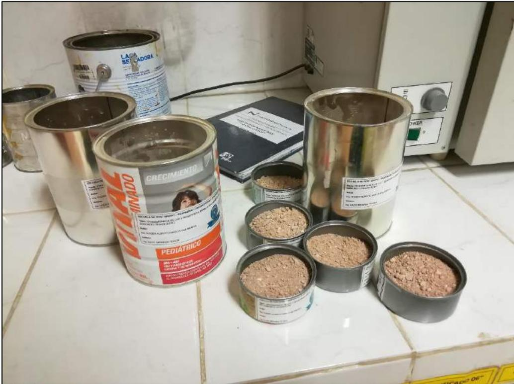
**Figura 22: Arena fina secada después de 24 horas en el horno para ser pesadas y tomar registro**
