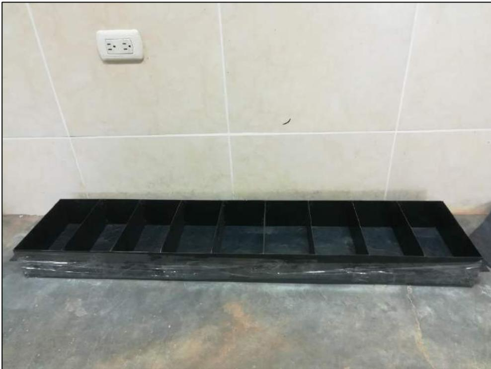
**Figura 12: Gavera metálica para la elaboración de ladrillos de 23 cm x 12 cm x 9 cm**
