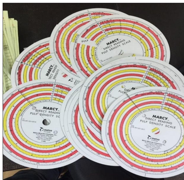
Figura 37. Discos intercambiables según peso específico de los sólidos.
