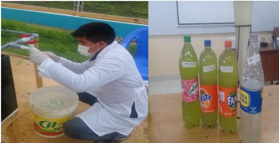
Foto 10. Medición de caudal y recojo de muestras para pre análisis.
