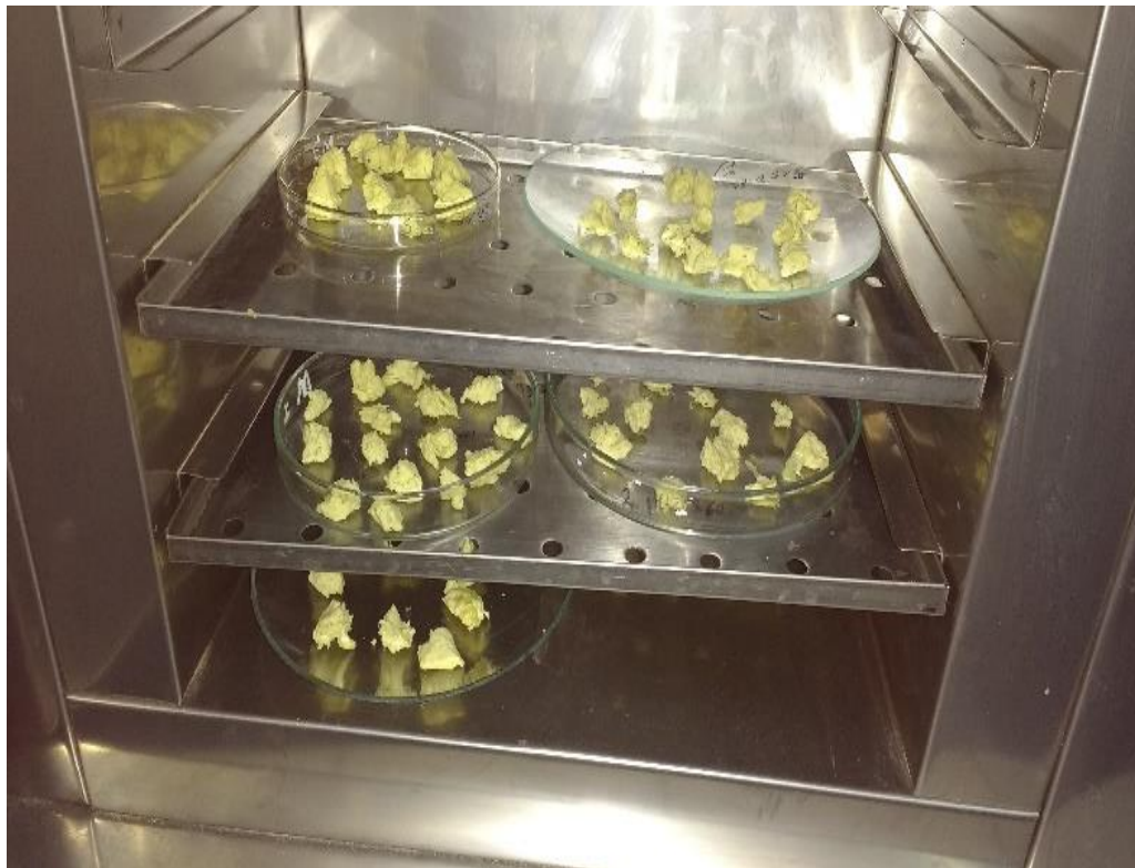
Figura 17. Albedos de naranja secados en la estufa a 40 ° C por 12 h
