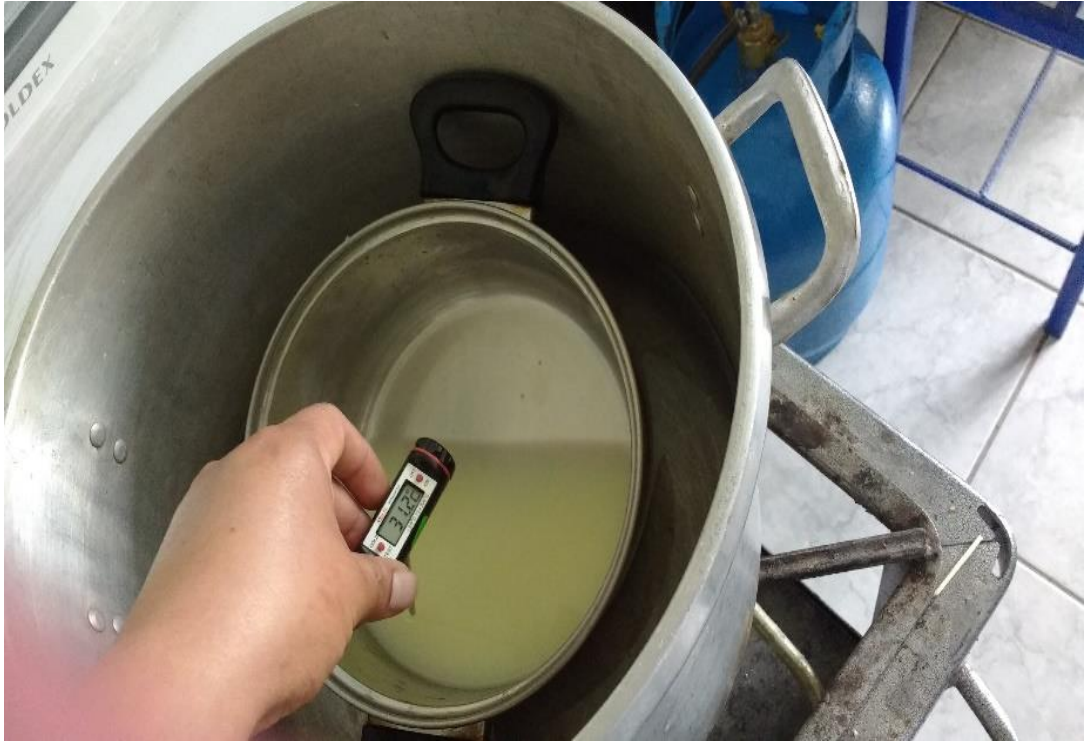
Figura 14. Etapa de concentración a una T = 65\text{ }^{\circ}\text{C} por un tiempo de 45 minutos
