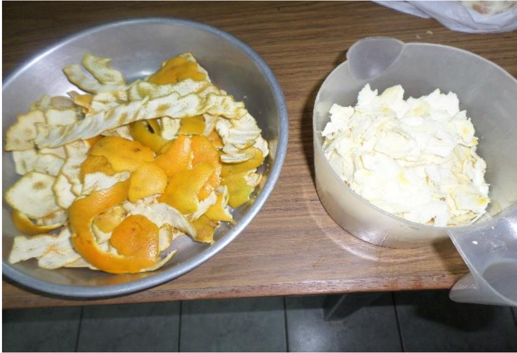
Figura 10. La separación de flavedo y albedo para la extracción de pectina
