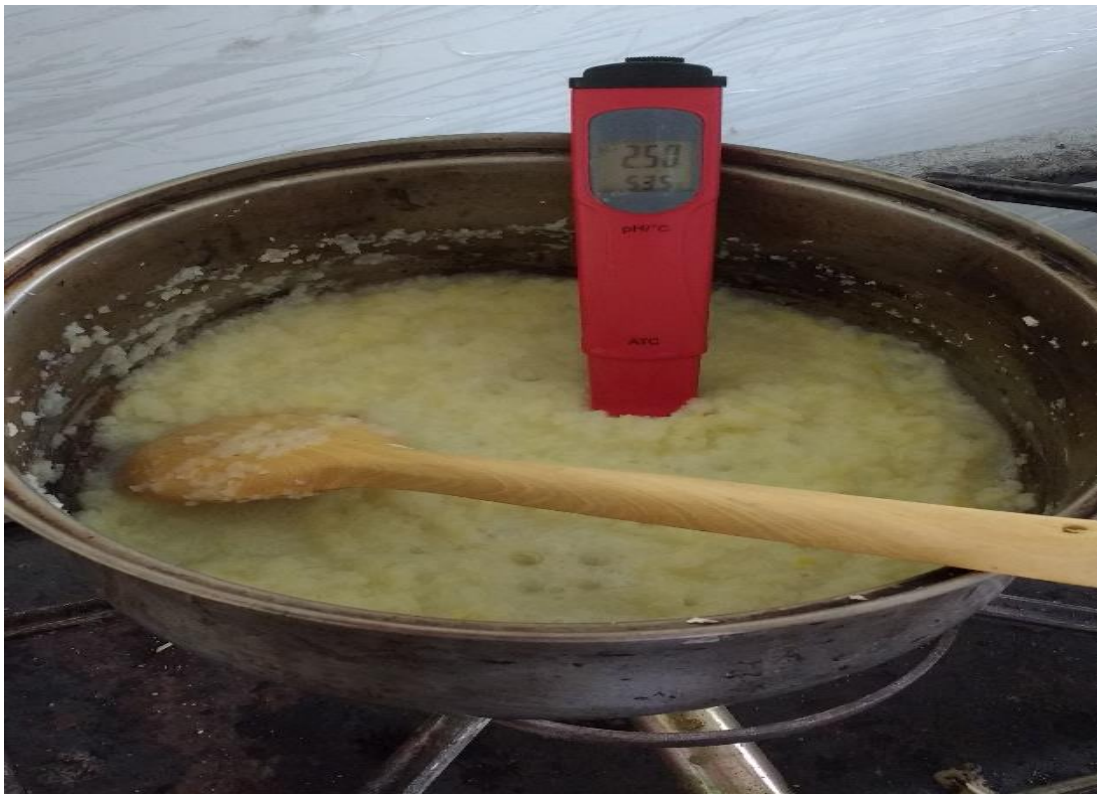
Figura 13. Etapa de hidrólisis, a una T = 85\text{ }^{\circ}\text{C} , \text{pH} = 2,5 y t = 45 minutos
