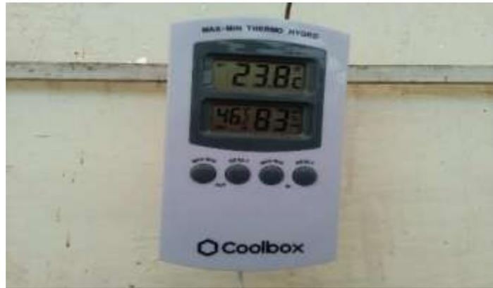
**Figura 16:** Equipo de medición de Temperatura y Humedad Relativa
