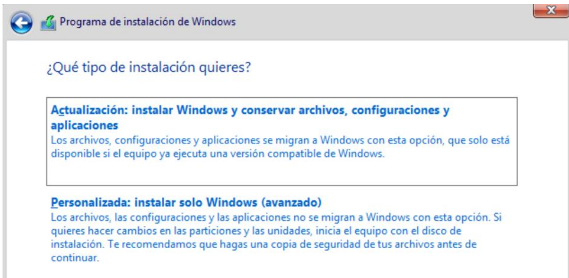
Ilustración 25: Selección del tipo de Instalación a realizar
