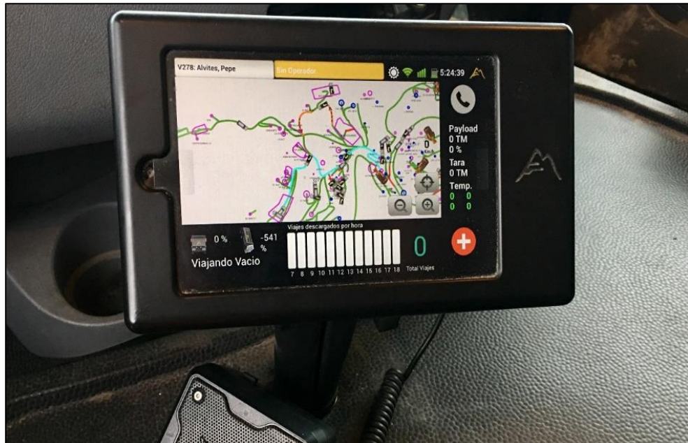
Figura 22 Hardware ControlSense instalado en volquete.
