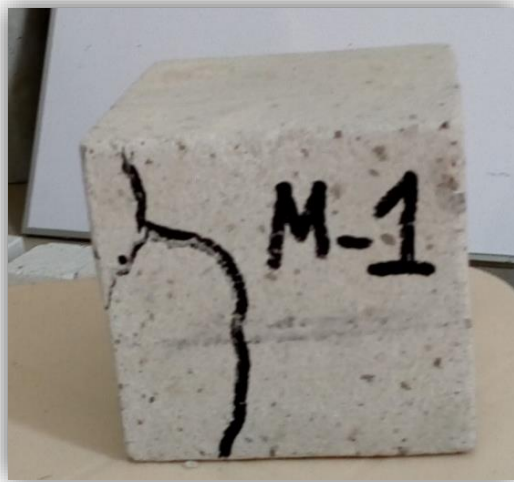
Figura N° 75: Falla en la muestra luego de ser sometida a compresión axial
