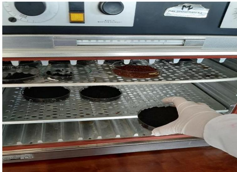
**Figura 8.** Determinación de humedad en la borra de café
