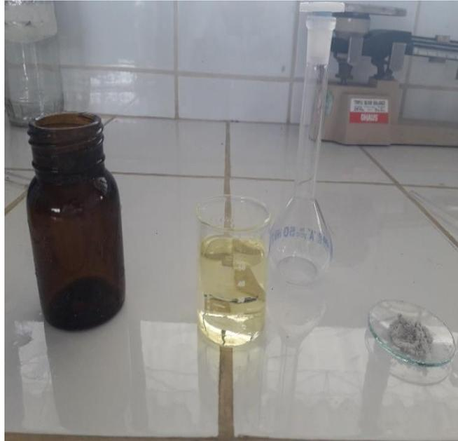
**Figura 11.** Preparación de difenilcarbazona 5mg/L
