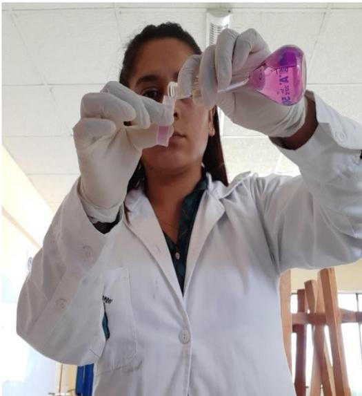
**Figura 22.** Colocación de soluciones en celdas fotométricas
