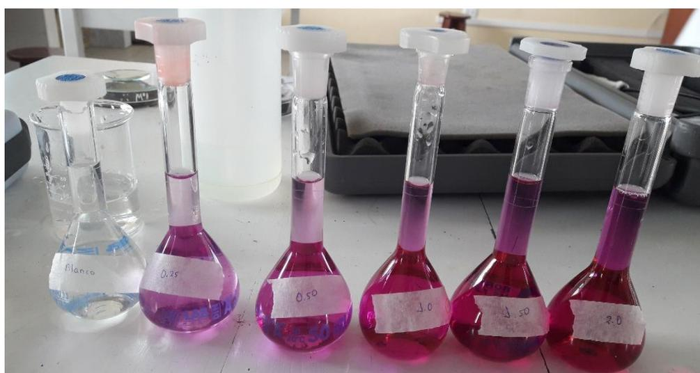
**Figura 13.** Curva de calibración de 50 ppm
