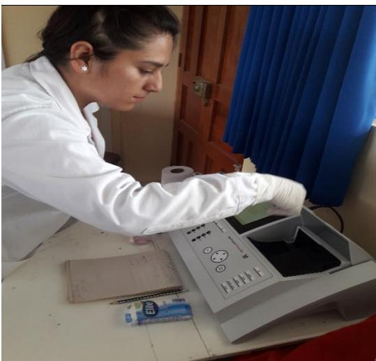
**Figura 56.** Lecturas en espectrofotómetro a 540nm
