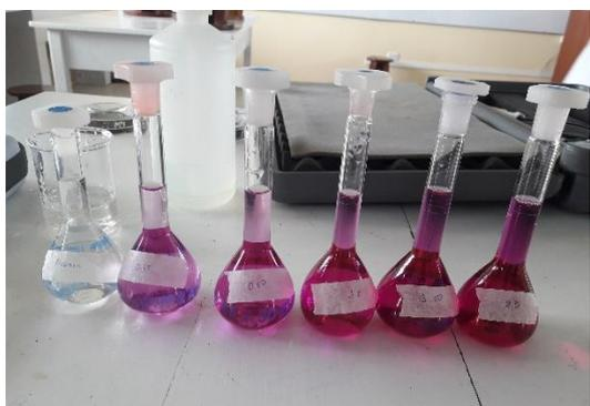
**Figura 52.** Curvas de calibración de 10 ppm
