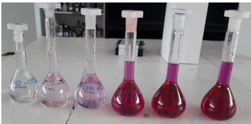
**Figura 12.** Curva de calibración de 10 ppm
