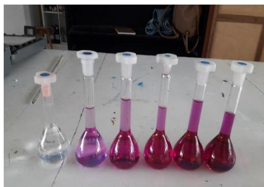
**Figura 51.** Curva de calibración de 50 ppm
