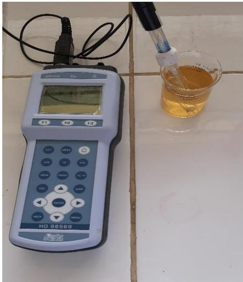
Figura 18. Ajuste de pH
