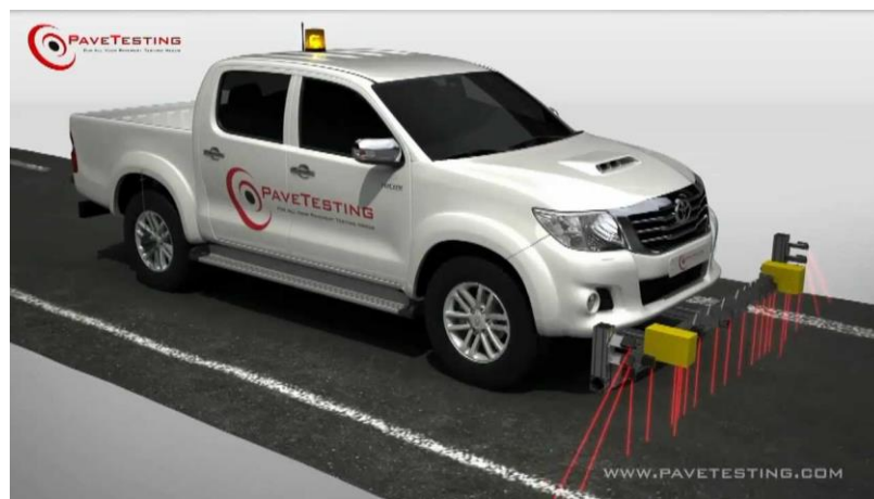
Figura N° 07. Equipo de clase I: Perfilometro Laser
