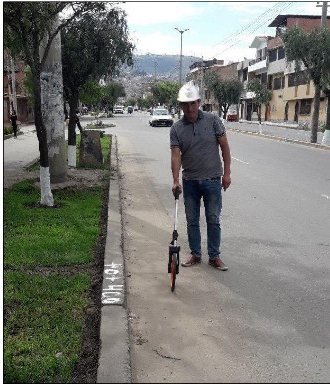
Fotografía N° 11. medida y marcación de muestra (UM-02)
