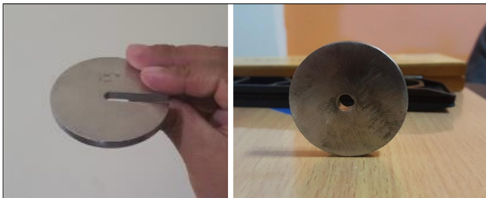
Fotografía N° 27. Pastilla o disco circular de bronce. Colocado debajo del apoyo móvil del Rugosímetro de Merlin para su nivelación.
