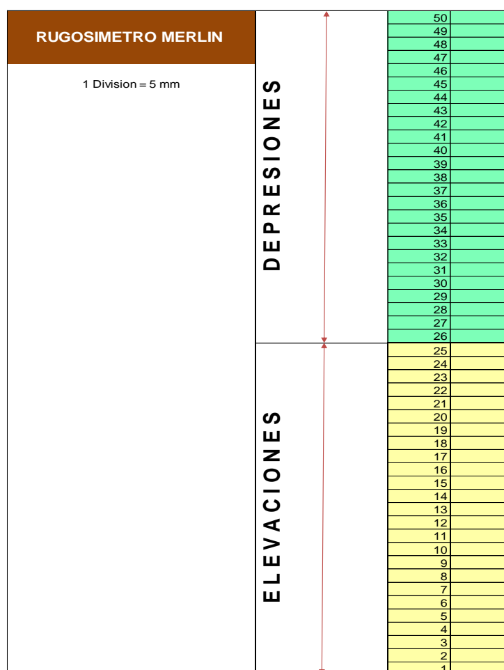
Figura N° 14. Escala para determinar la dispersión de las desviaciones de la superficie del pavimento respecto del nivel de referencia o cuerda promedio.
