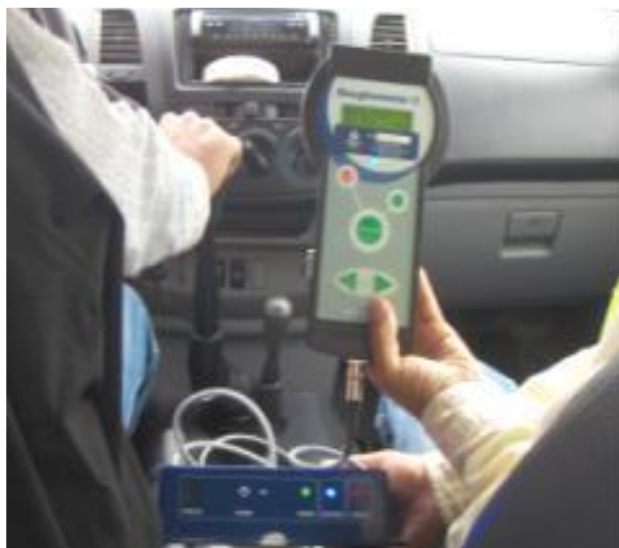
Figura N° 11. Equipo de clase III: Roughometer II
