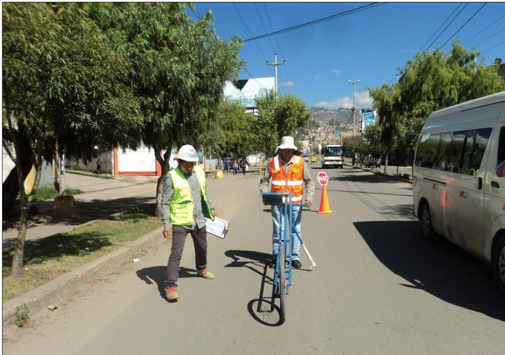
Fotografía N° 18. Lectura y toma de datos con Merlin, Calzada 1 (ida), km 00+160.
