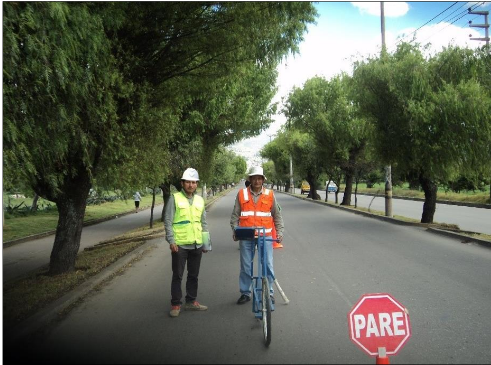
Fotografía N° 23. Lectura y toma de datos con Merlin, Calzada 1 (ida), km 02+560 – Altura de Bella Unión
