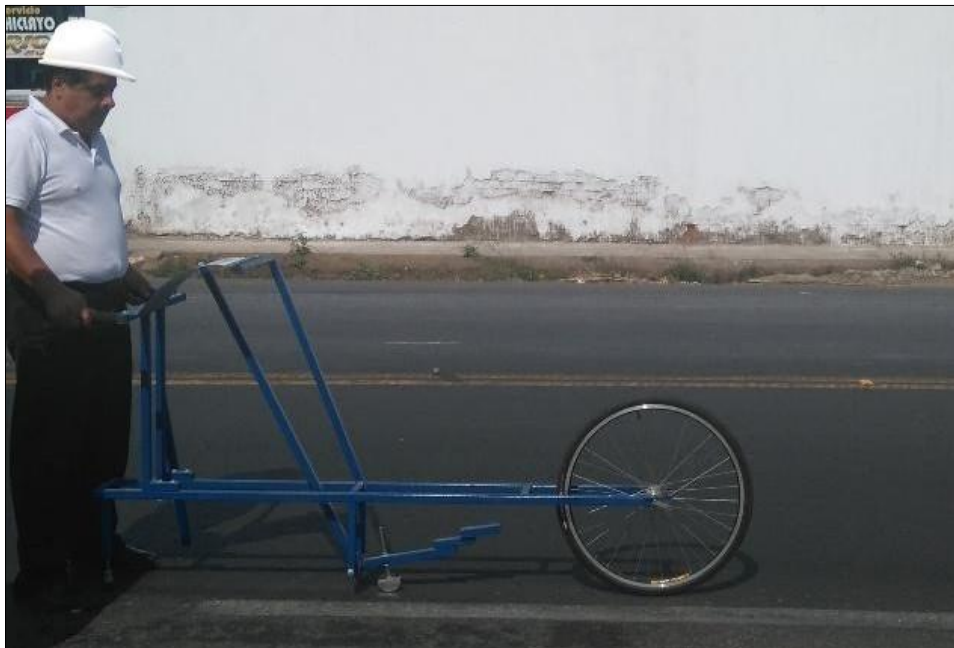
Fotografía N° 16. Técnico dando el visto bueno y verificando la calibración del Rugosímetro de Merlin; previo a la toma de datos.
