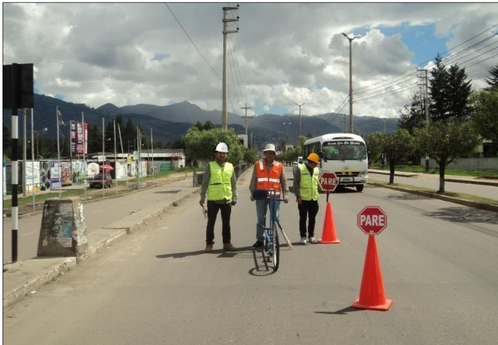
Fotografía N° 24: Lectura y toma de datos con Merlin, Calzada 1 (ida), km 03+600 (Fongal)
