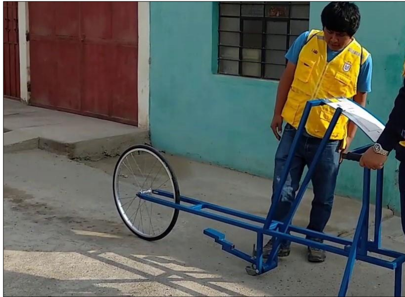
Fotografía N° 15. Verificación del Rugosímetro de Merlin para para dar inicio al registro de mediciones.
