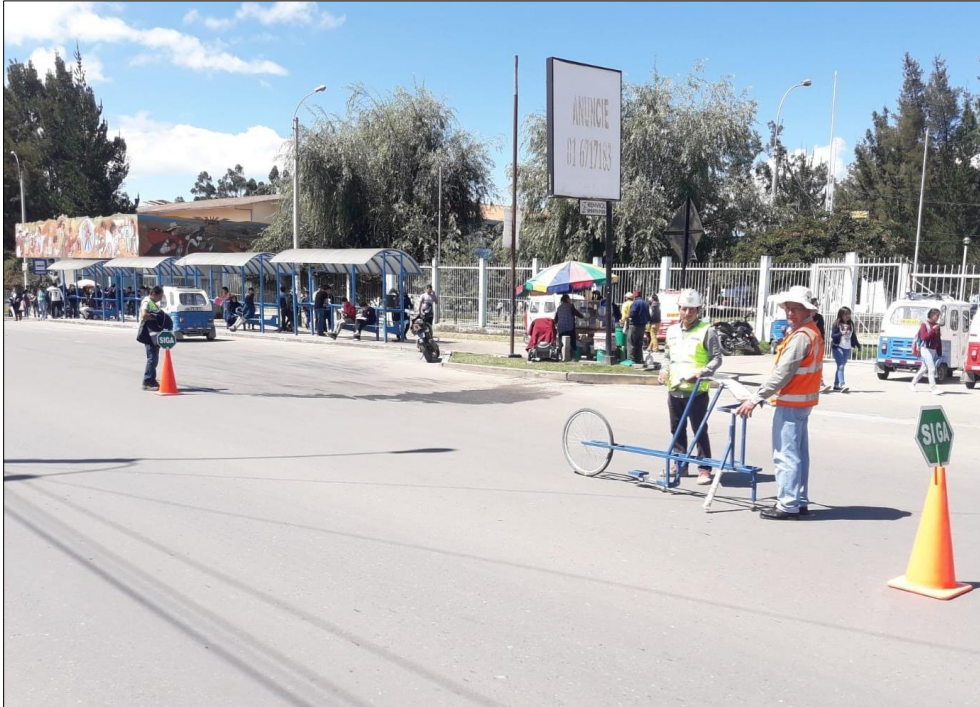
Fotografía N° 21. Lectura y toma de datos con Merlin, Calzada 1 (ida), km 00+730 – Altura UNC
