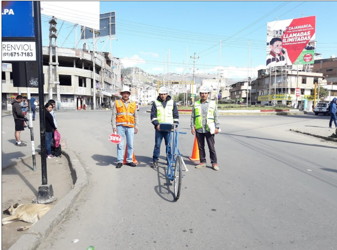
Fotografía N° 17. Inicio de toma de datos con el Rugosímetro de Merlin, UM 01 - Calzada 1 (ida), (Rotonda Musical - Cajamarca), Km 00+000m
