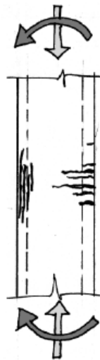
Figura 15: Fisuras por flexión compuesta.
