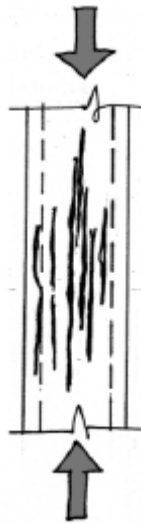
Figura 16: Fisuras por compresión simple.
