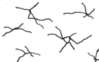
Figura 25: Fisuración en estrella.
