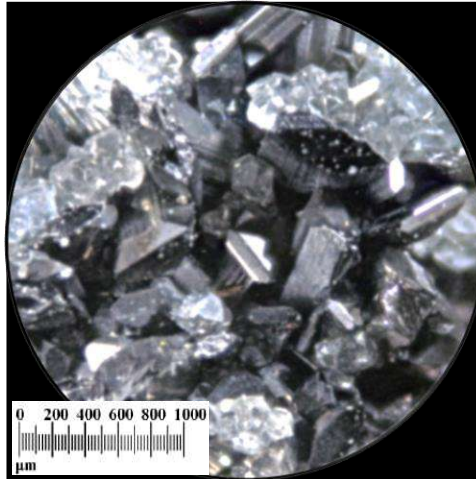
Fotomicrografía 1: Enargita de color negro gris a hierro con hábito euhedral y subhedral. (Vista aumentada 60x de la muestra MSN-01).
