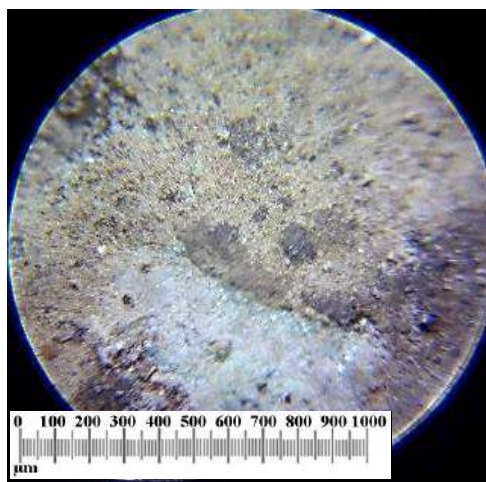
Fotomicrografía 20: Montmorillonita e illita en hábito terroso y micas de color blanco a gris. (Vista aumentada 100x de la muestra MSN-10).
