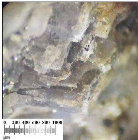
Fotomicrografía 14: Baritina en sistema ortorrómbico de color blanquecino. (Vista aumentada a 60x de la muestra MSN-07).
