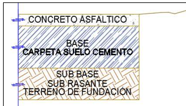
Figura N° 3 Estructura típica de pavimento semirrígido.
