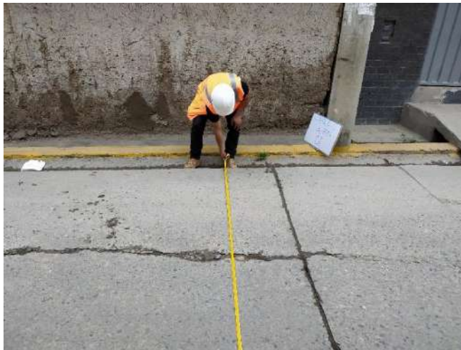
Foto. 20 Toma de Datos de la Sección de la Vía.
