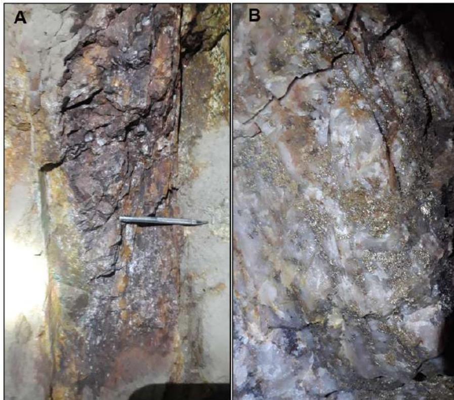
Foto 5. Variación de la mineralización ene veta Filomena, A: Cuarzo con óxidos de hierro del nivel 7, B: Cuarzo con sulfuros nivel 14.
