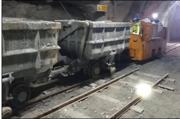
Figura 16. Extracción de mineral con locomotora a batería
