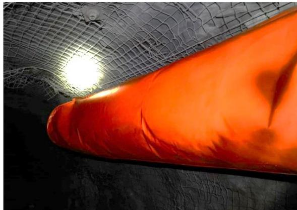
Figura 4. Manga de Ventilación en una labor horizontal
