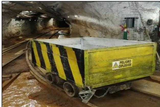
Figura 9. Calesa para el traslado de explosivos y accesorios
