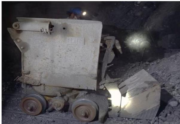
Figura 13. Limpieza de frente de 8'x 8' con pala neumática
