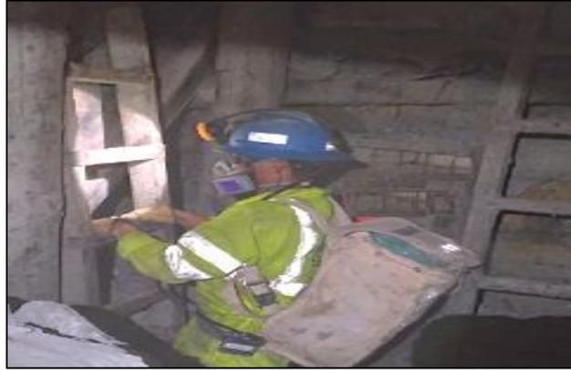
Figura 20. Traslado de explosivos por el camino de la chimenea
