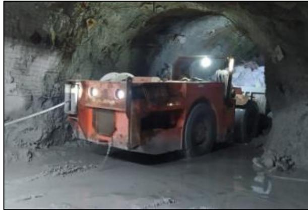
Figura 14. Limpieza de carga con scoop eléctrico
