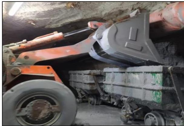
Figura 15. Carguío del scoop eléctrico hacia el carro minero.
