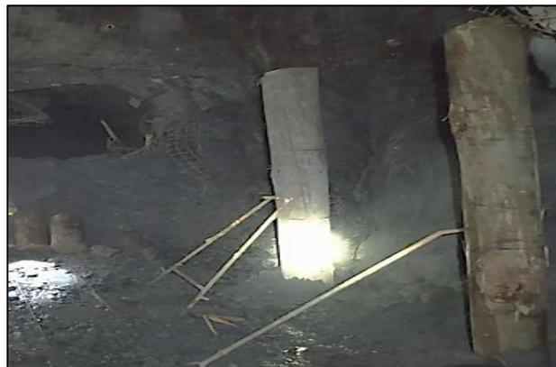
Figura 17. Colocación de cuadro base con trípodes para la tolva de la chimenea
