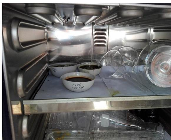
Foto 5. Café en estufa a 120°C para la obtención del extracto hidroalcohólico en forma seca.
