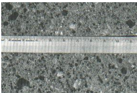
Figura 17 Pulimento de agregados
