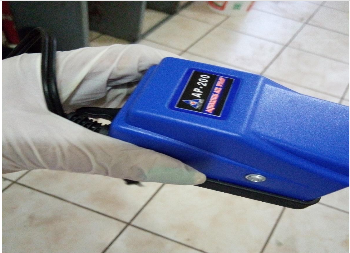
Foto 1: Bombas de aire Rs electrical Rs 083 1.6l/h
