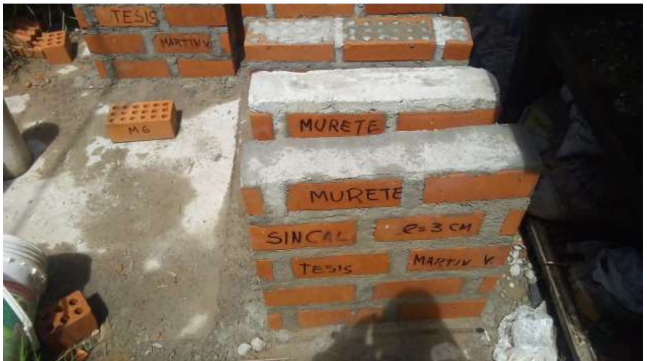
Fotografía 19. Muretes realizados, considerando morteros con y sin cal, así como diferentes espesores.
