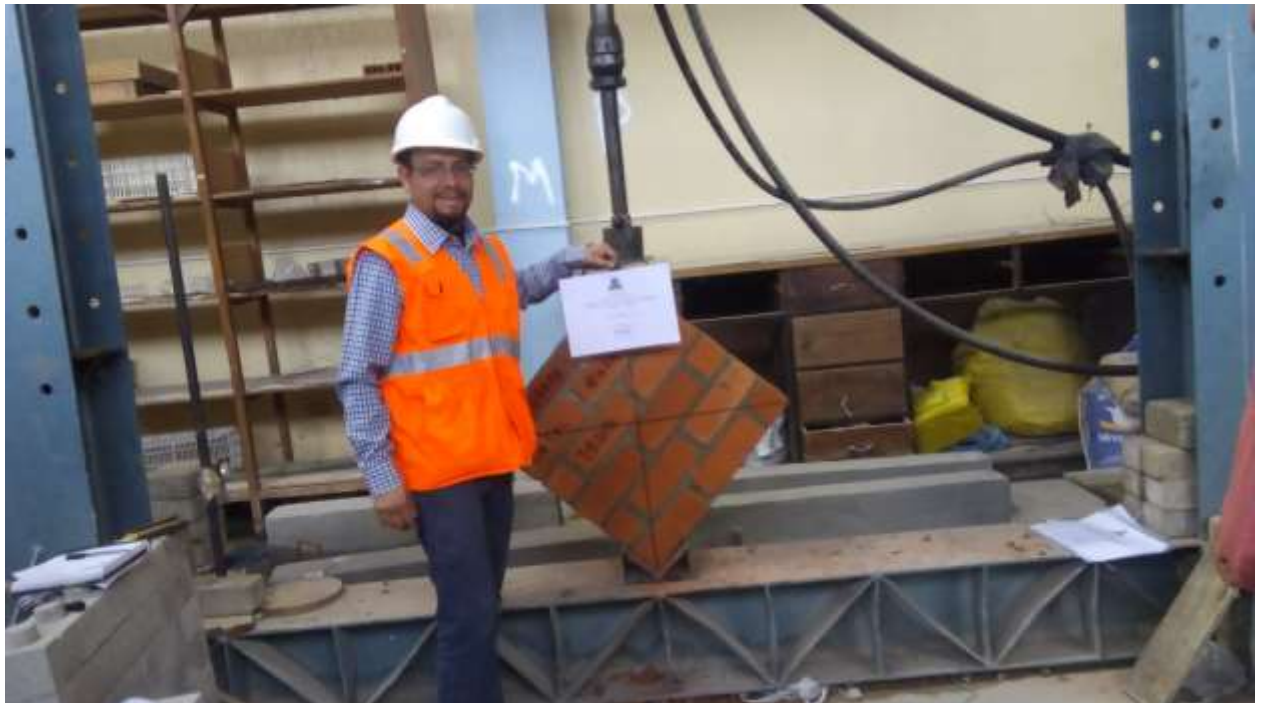
Fotografía 21. Ensayo a compresión diagonal, en murete con mortero sin cal, espesor de 1 cm, para el cálculo de la resistencia característica al corte.
