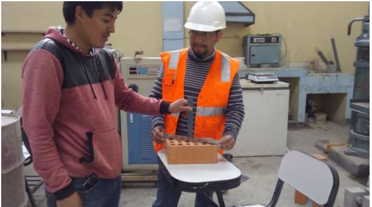
Fotografía 13. Determinando el alabeo de la cara superior del ladrillo (ensayo de alabeo).
