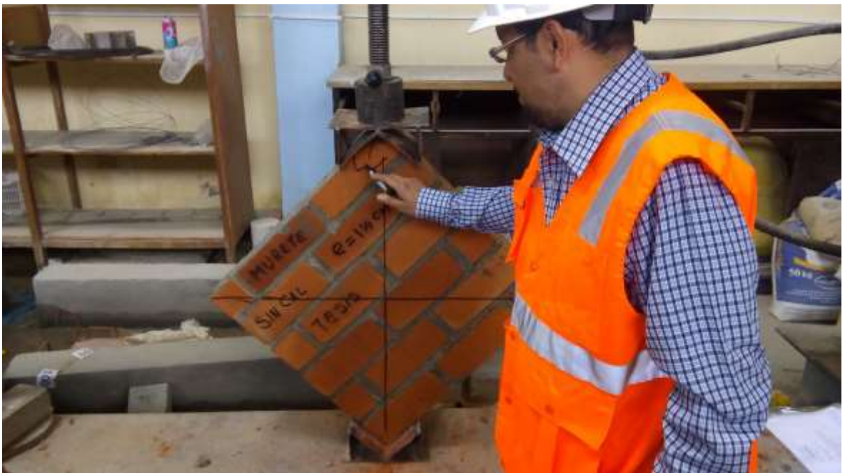
Fotografía 27. Ensayo a compresión diagonal, en murete con mortero sin cal, espesor de 1.5 cm, para el cálculo de la resistencia característica al corte, donde existió una falla a través de la junta diagonal.
