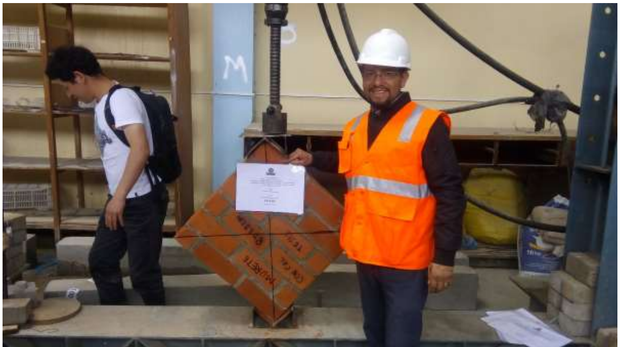
Fotografía 25. Ensayo a compresión diagonal, en murete con mortero tipo P2, con cal, espesor de 1.5 cm, para el cálculo de la resistencia característica al corte.
