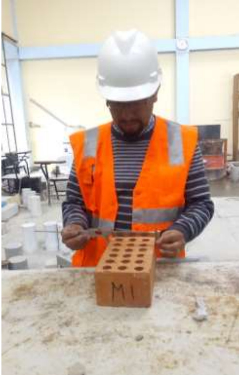
Fotografía 11. Medición de los lados de ladrillo para ensayo de variabilidad dimensional.
