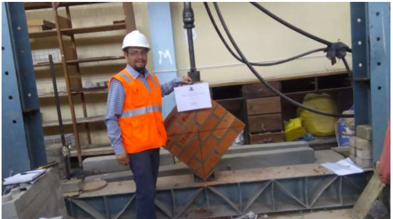
Fotografía 23. Ensayo a compresión diagonal, en murete con mortero sin cal, espesor de 3 cm, para el cálculo de la resistencia característica al corte.
