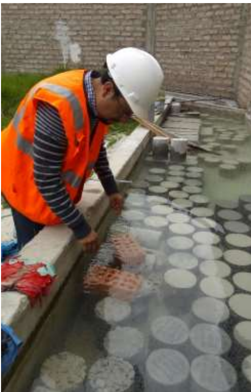
Fotografía 17. Colocación de ladrillos en poza para su sumergirlos por 24 h. para realizar el ensayo de absorción.
