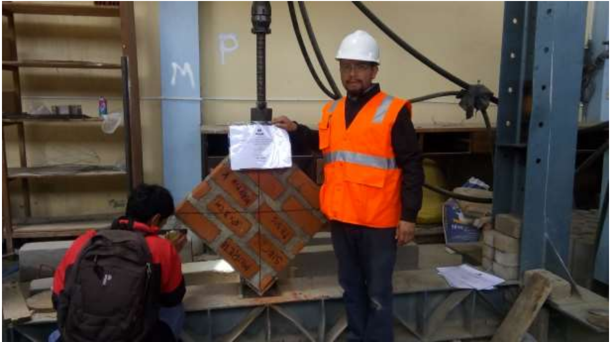
Fotografía 22. Ensayo a compresión diagonal, en murete con mortero sin cal, espesor de 3.0 cm, para el cálculo de la resistencia característica al corte.
