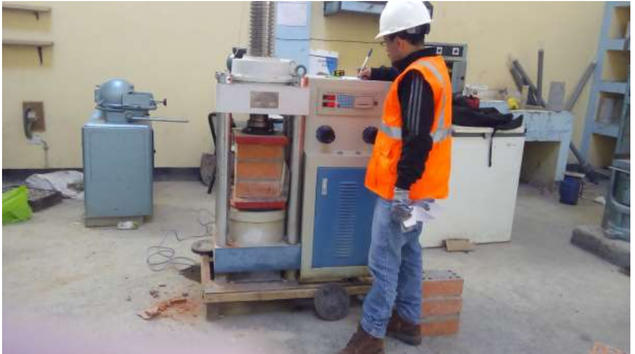
Fotografía 18. Toma de datos del ensayo a carga axial sobre pilas de unidades de albañilería.
