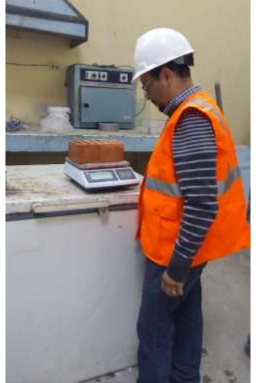
Fotografía 12. Pesaje de las unidades de albañilería.
