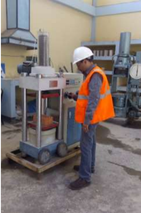
Fotografía 15. Ensayo a la compresión axial de ladrillos.
