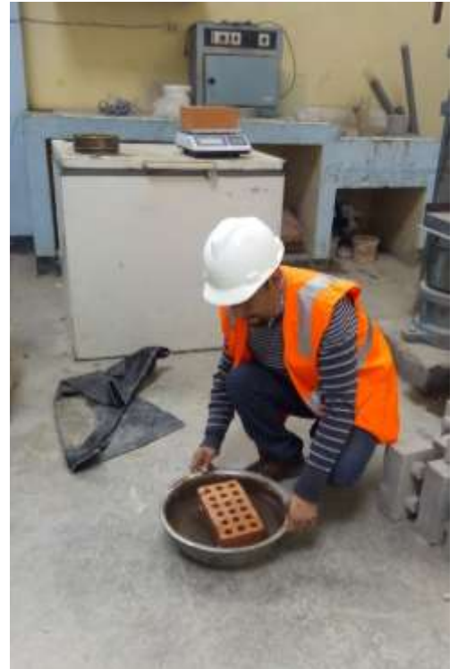
Fotografía 14. Colocación de unidades de albañilería sobre agua, con un nivel de 3 mm, por espacio de 1 min (ensayo de succión).
