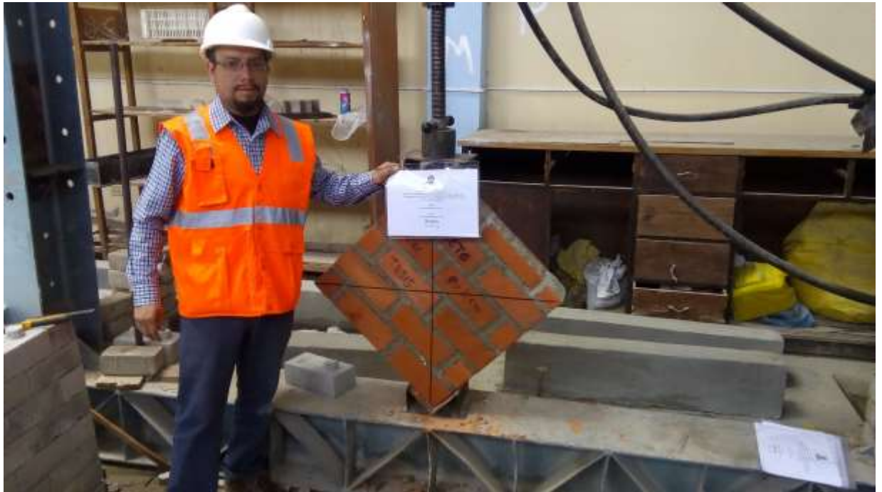
Fotografía 24. Ensayo a compresión diagonal, en murete con mortero tipo P2, con cal, espesor de 2 cm, para el cálculo de la resistencia característica al corte.
