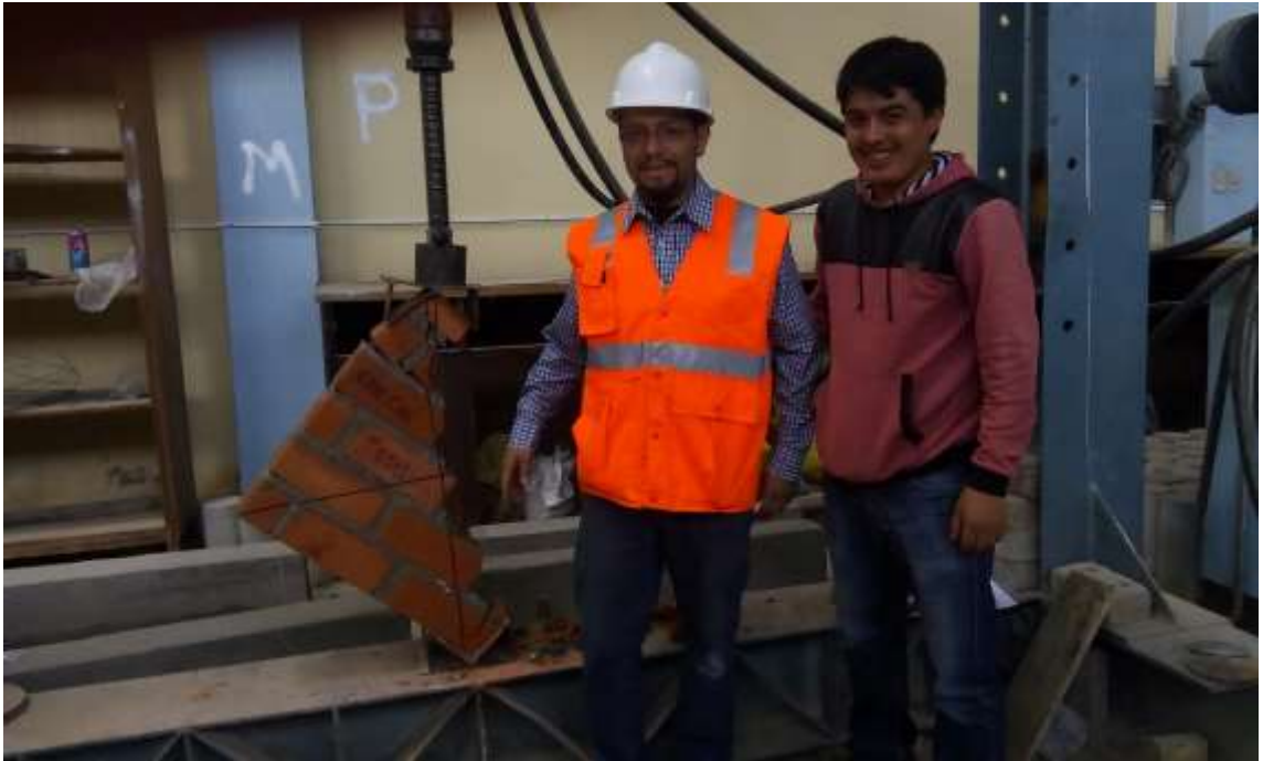
Fotografía 26. Ensayo a compresión diagonal, en murete con mortero tipo P2, con cal, espesor de 1.5 cm, para el cálculo de la resistencia característica al corte, donde se muestra una falla escalonada en la diagonal del murete, teniendo un sonido estruendoso en el momento de fractura.
