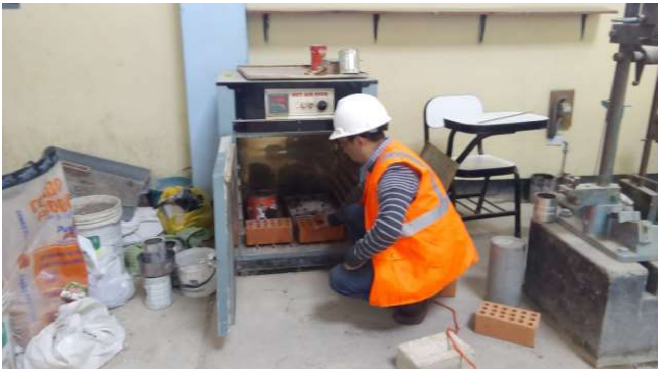
Fotografía 10. Colocación de las unidades de albañilería al horno, a fin de determinar la humedad natural.
