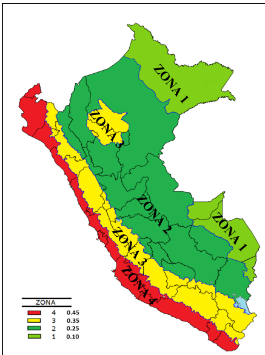
Figura 2.5. Zonas sísmicas en el Perú. Fuente: Ministerio de Vivienda, Construcción y Saneamiento, 2019.
