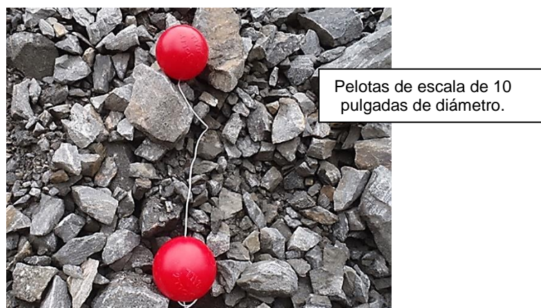
Figura 15. Escalas de fragmentación en material volado (Split Desktop)
